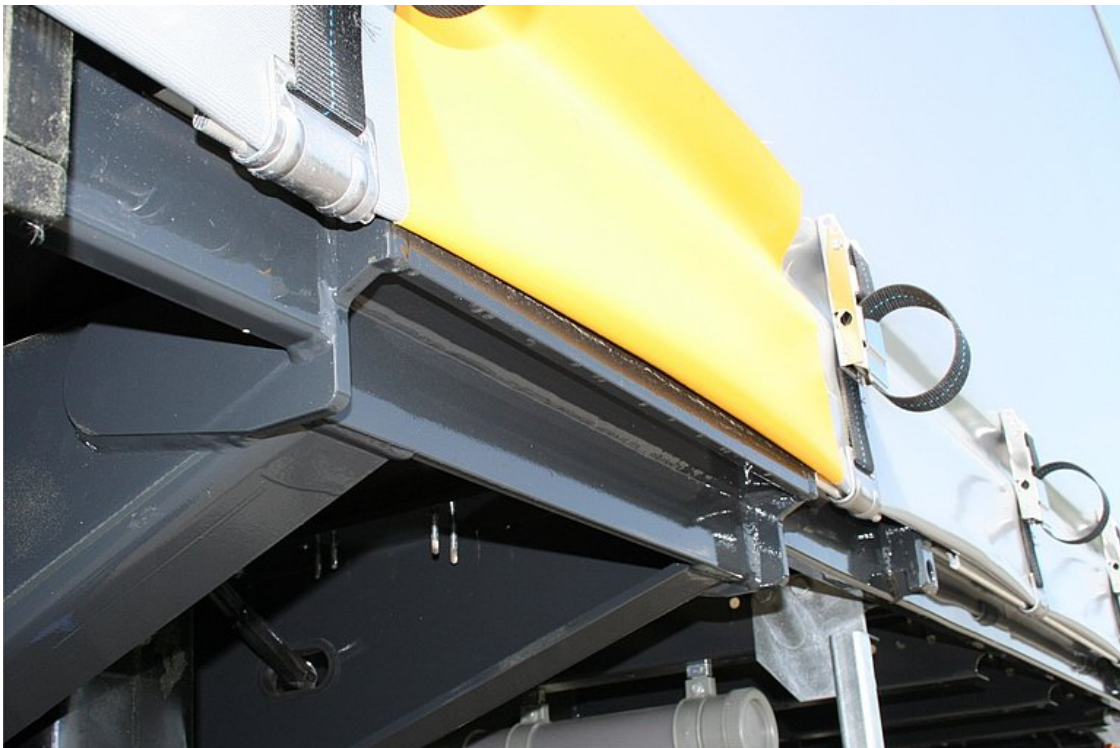
Rahmenkonstruktion verstärkt mit 4 Greifkanten für kranbare Bahnverladung
