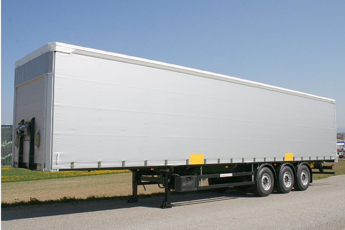
Korrosionsarme hochwertige Aluminium-Aufbaukomponenten, geprüft nach EN 12642 XL
