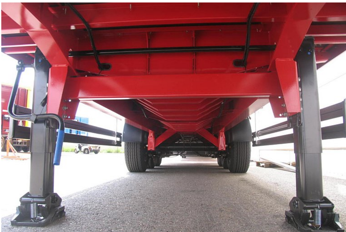
Verstärkte Rahmenkonstruktion für Coiltransporte 30 t im Schwerpunkt auf mindestens 1.500 mm Ladelänge
