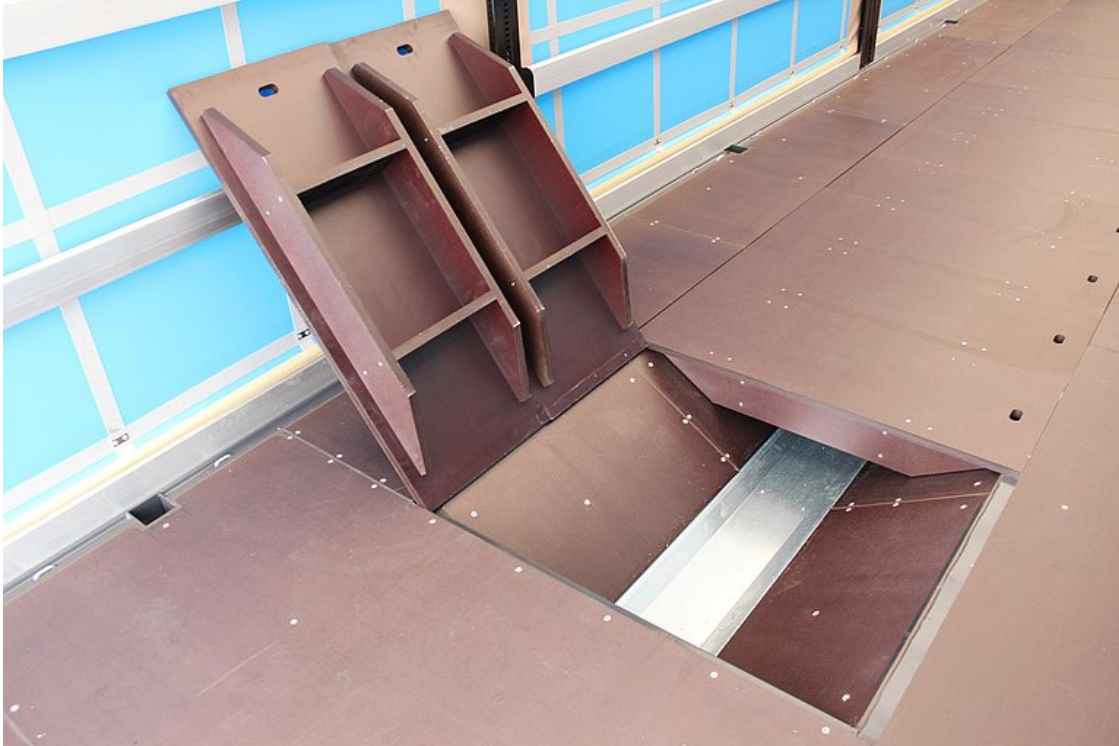
Staplerbefahrbare Muldenabdeckung aus 27 mm Siebdruckplatte mit Unterzug
