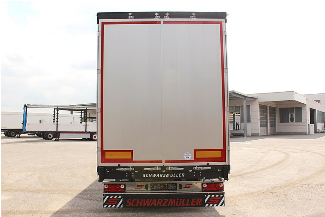
Hinten angeschraubtes Portal mit Aluminium-Ecksäulen, samt vollumschlabarerer Doppeltüre in Profilbauweise
