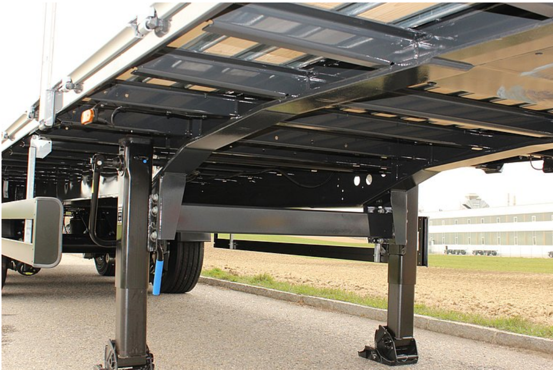
Verstärkte Rahmenkonstruktion für Punktbelastung 20 t auf 4 m im Schwerpunkt
