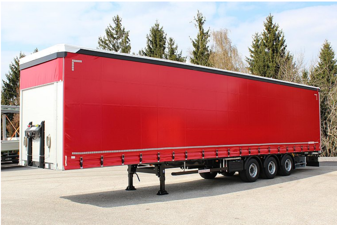
Korrosionsarme hochwertige Aluminium-Aufbaukomponenten, geprüft nach EN 12642
