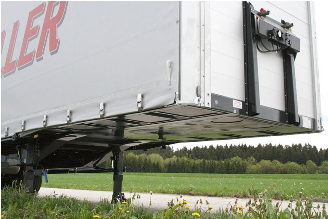
Niedrige Rahmenbauhöhe 80 mm für Lowliner-Zugmaschinen und bis zu 3.000 mm Innenhöhe
