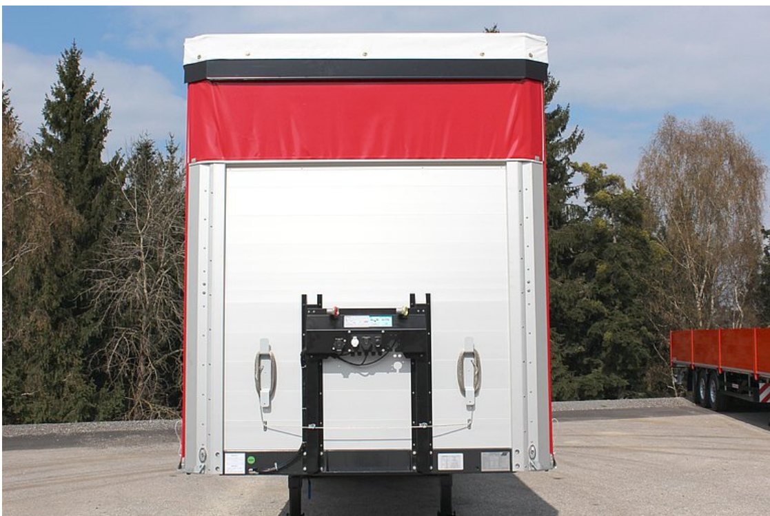
Verstärkte Aluminium-Hohlprofil-Vorderwand mit integriertem Gerätehalter
