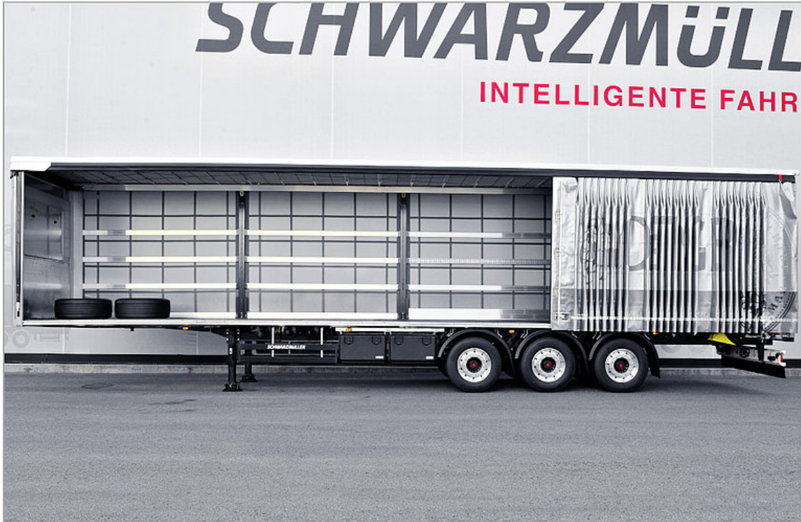
OPTIONAL: Quick-Slider: Mit diesem Öffnungssystem wird die Seitenplane in 5 sek. geöffnet oder geschlossen.
