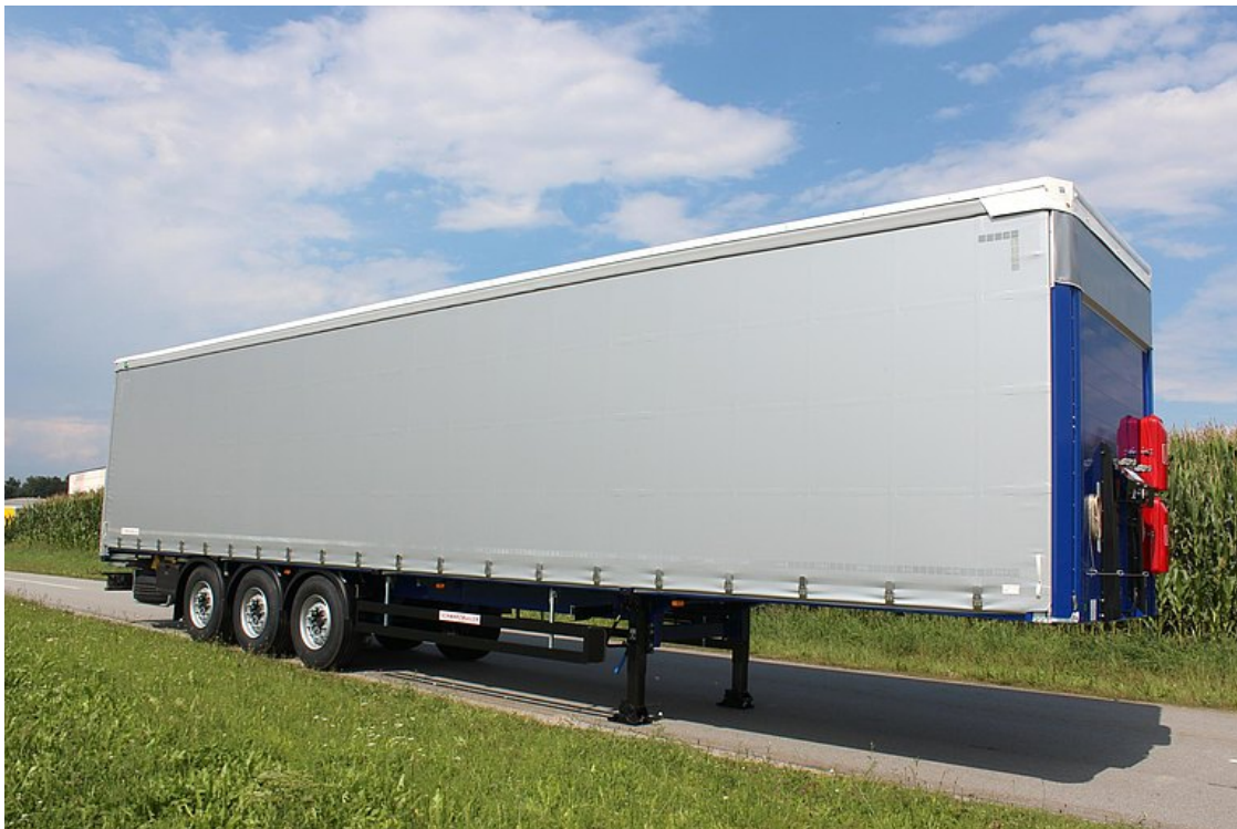
Korrosionsarme hochwertige Aluminium-Aufbaukomponenten, geprüft nach EN 13642 XL
