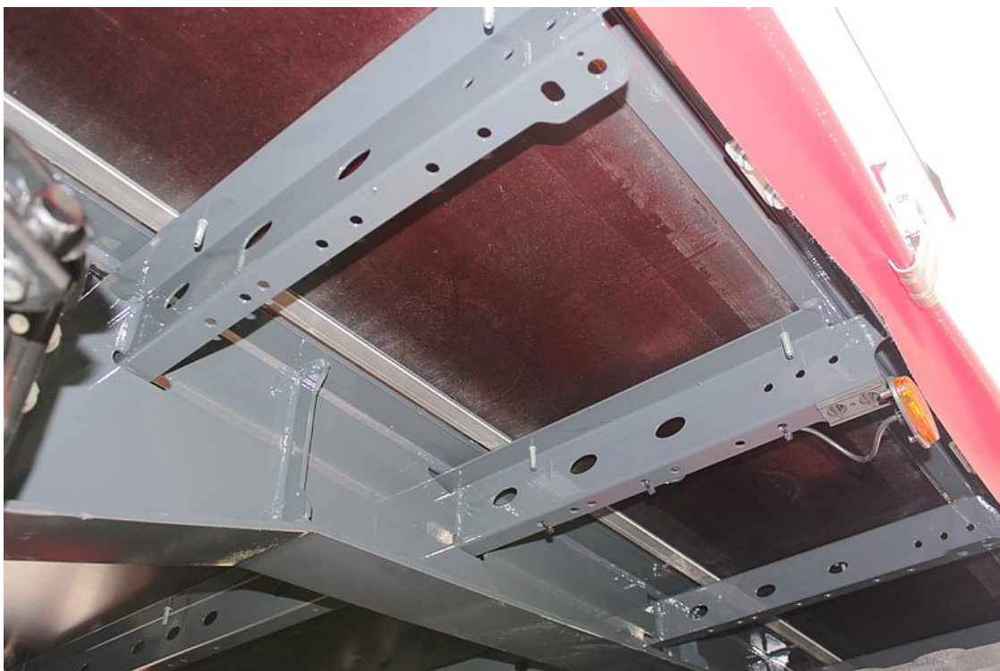
Siebdruckplattenboden 27 mm, mit Außenrahmen bündig, sowie mit 2 Stahl-Hutprofilschienen über den Längsträgern (Staplerachslast 7 t)
