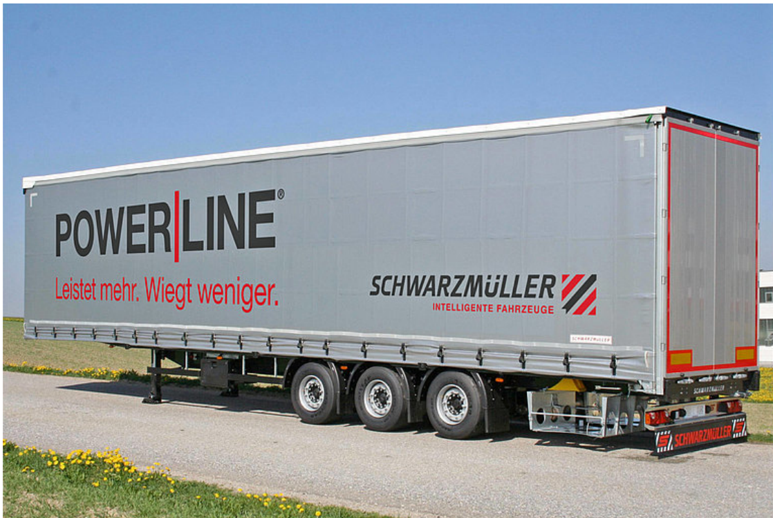
Korrosionsarme hochwertige Aluminium-Aufbaukomponenten, geprüft nach EN 12642 Code XL
