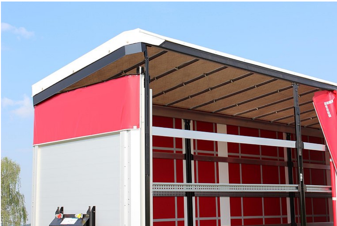
Handhydraulisches Hubdach 400 mm anhebbar für schnelle Be- und Entladung
