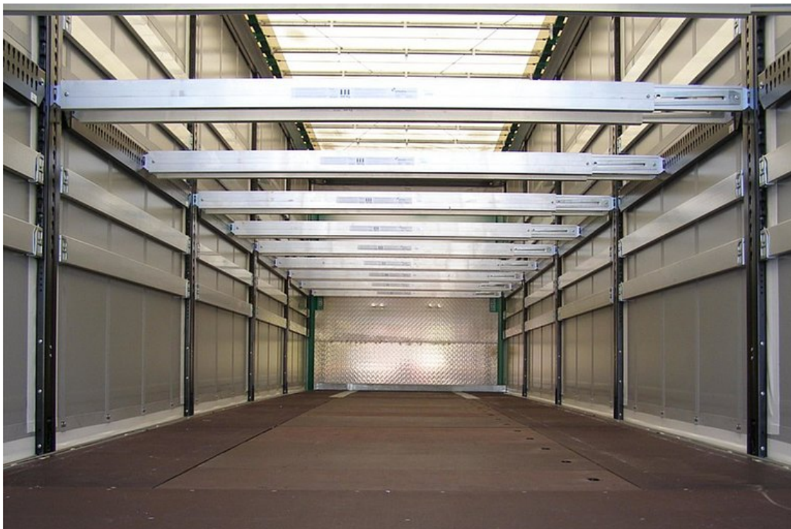
Doppelstock-Verladeeinrichtung CTD III für 33 Euro-Norm-Paletten auf der 2. Ladeebene
