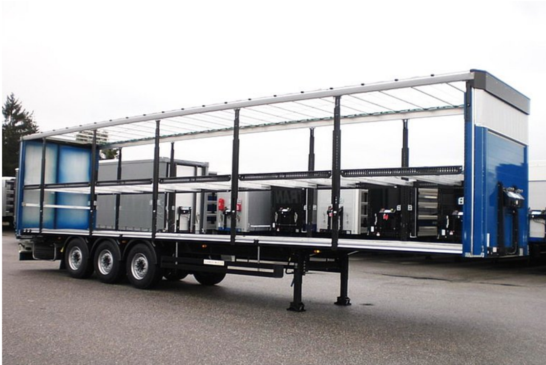
3-Achs-Schiebleplanen-Plateausattelanhänger mit Doppelstockverladeeinrichtung
