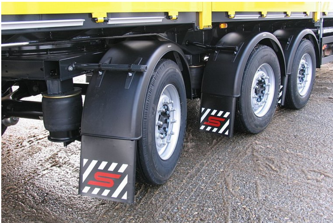
3. Aufliegerachse mit mechanischer Zwangslenkung
