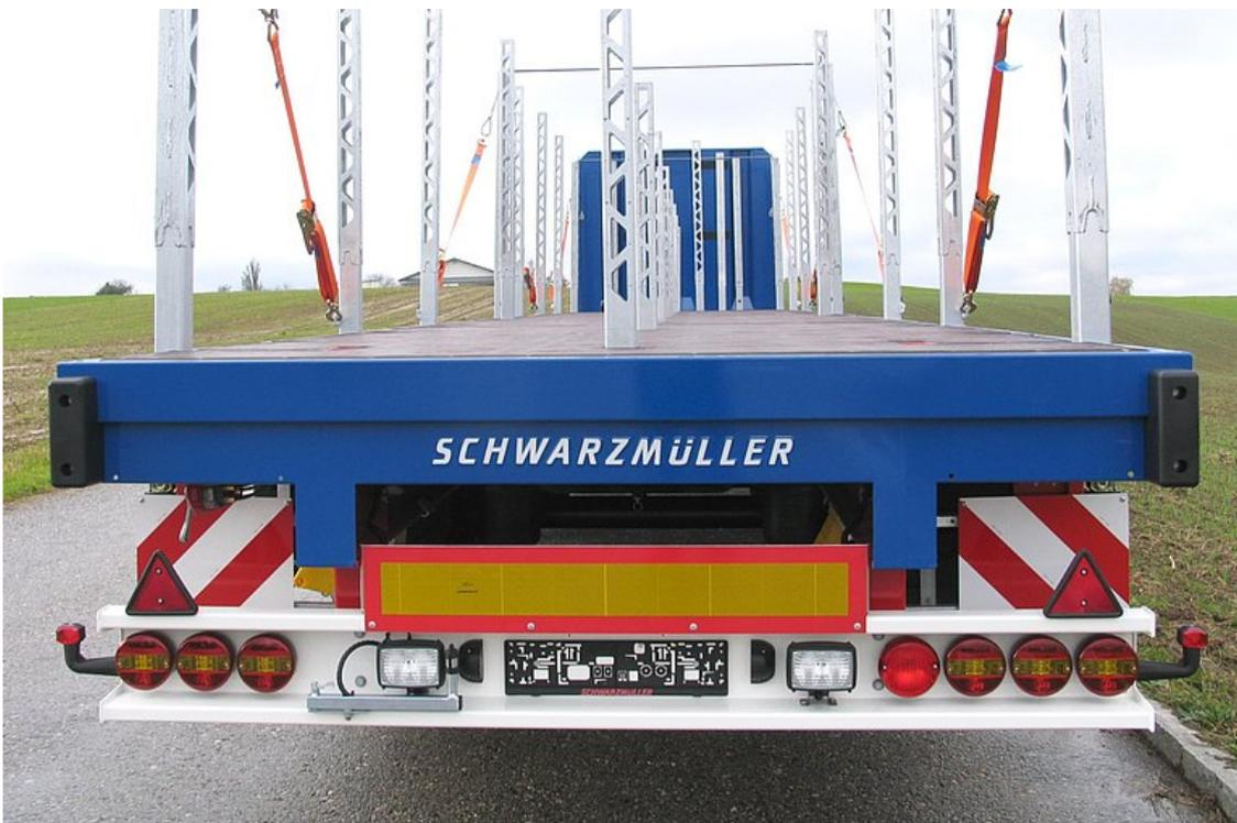
Unterfahrtschutz mit integriertem Heckleuchtensystem und Gummipuffer
