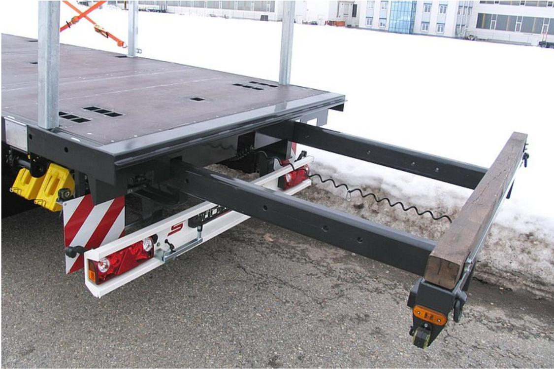
OPTIONAL: Rückwärtiges Ausziehgestell, 1.500 mm ausziehbar (2 t belastbar)
