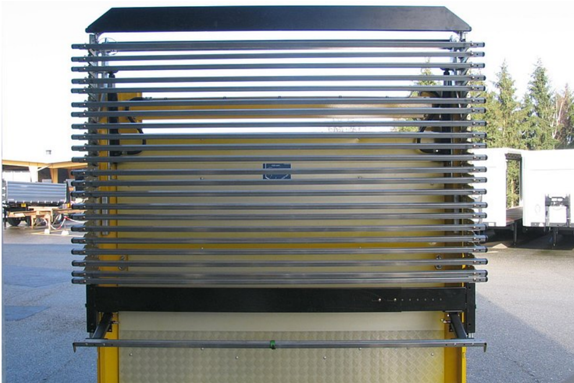
Schiebeverdeck an die Vorderwand innen hydraulisch abklappbar - für offene Blechtransporte
