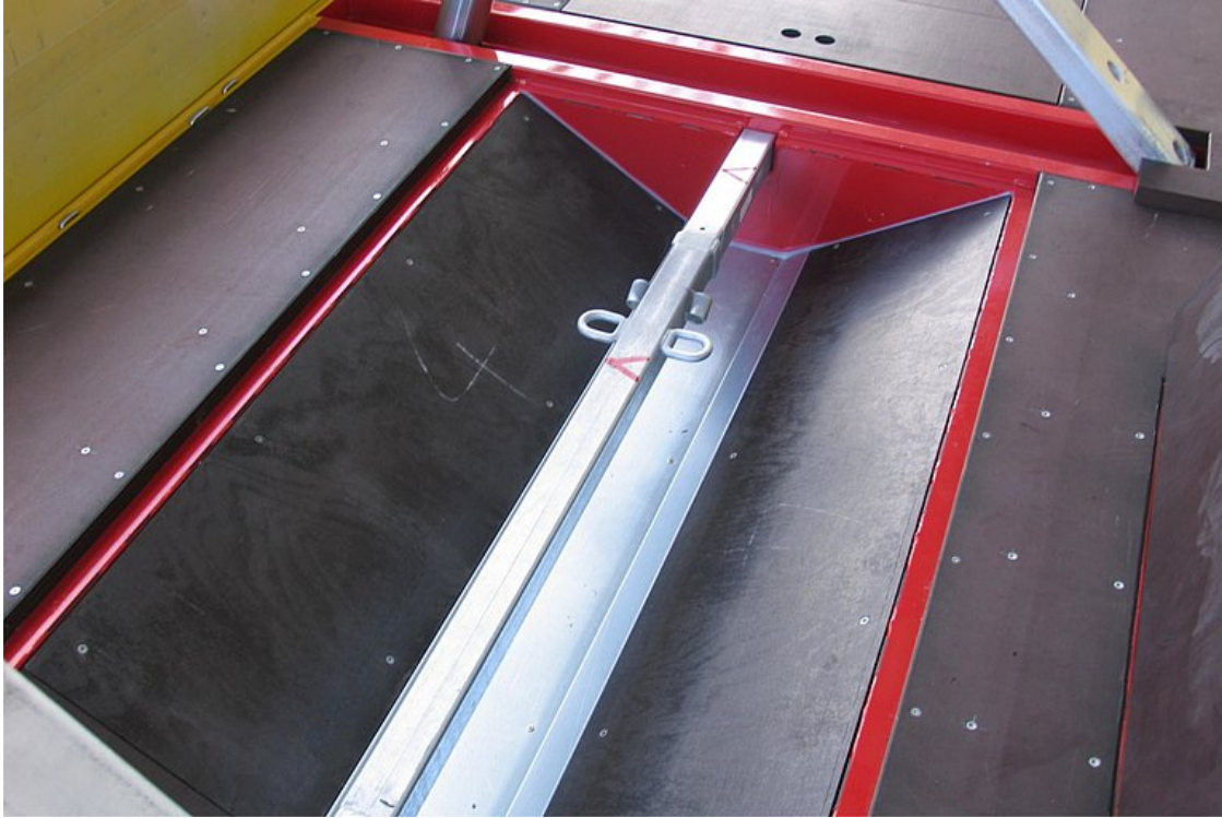
Coilmulde mit Nutzlänge 8.000 mm (in 3 Segmente aufgeteilt) für Coilsdiameter 900 bis max. 2.100 mm
