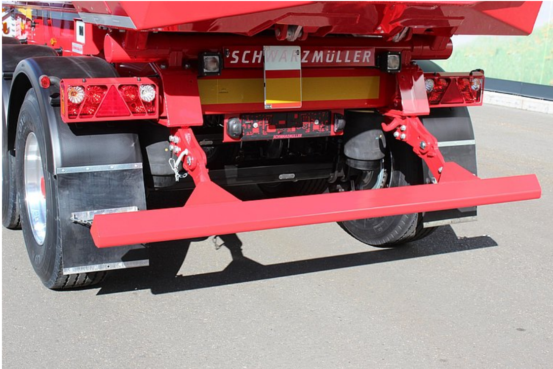
Aluminium-Trapez-Unterfahrschutz klappbar, optional pneum. hochklappbar
