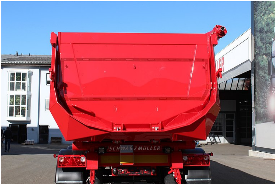
Isolierte Rückwand = Pendelwand mit versenkter Lagerung und autom.-mech- 2-Haken-Zentralverschluss
