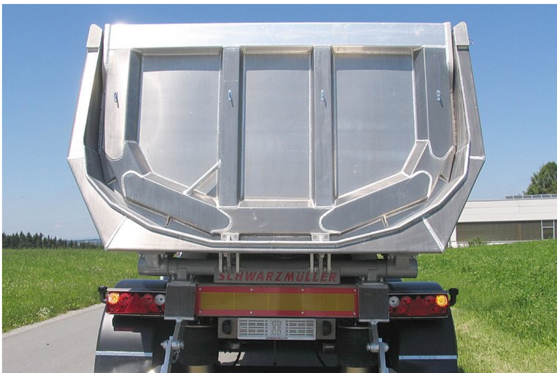
Rückwand = Pendelwand mit versenkter Lagerung und autom.-mech. 2-Haken-Zentralverschluss
