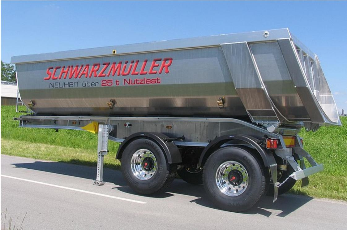
2-Achs-Vollaluminium-Segmentmulden-Kippsattelanhänger - Radstand 1.810 mm
