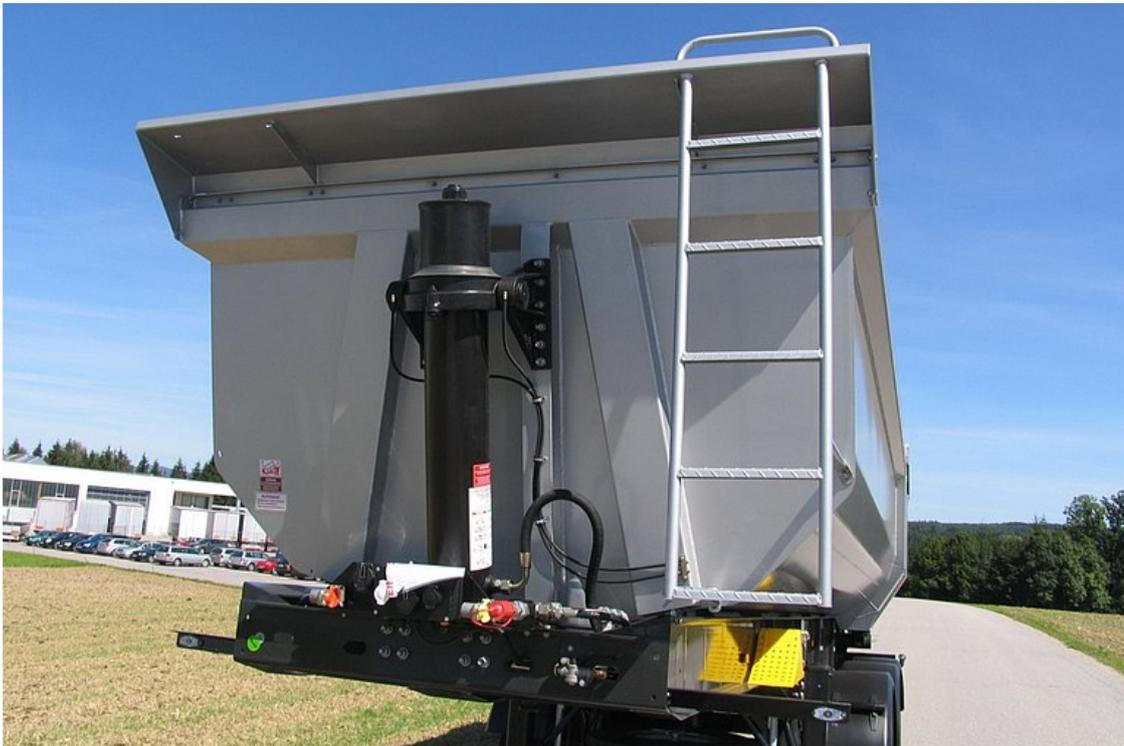
Optimale Lastverteilung durch schräge Vorderwand
