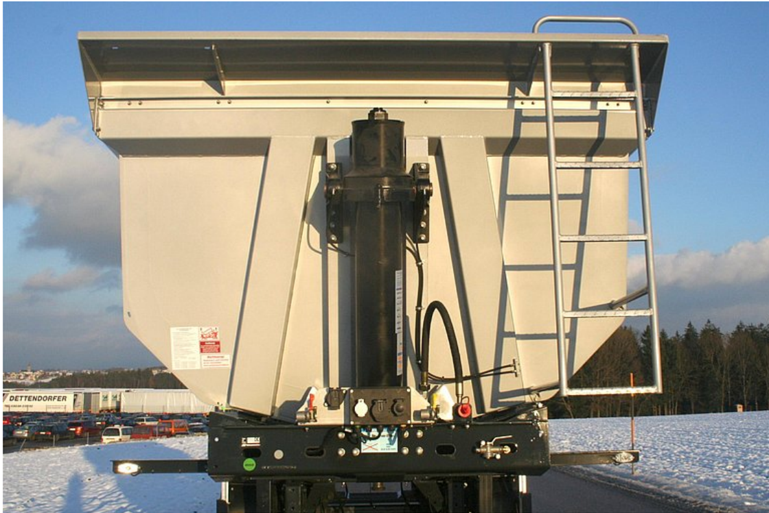
Schräge Vorderwand mit hartverchromtem, qualitativ hochwertigem Frontkippzylinder
