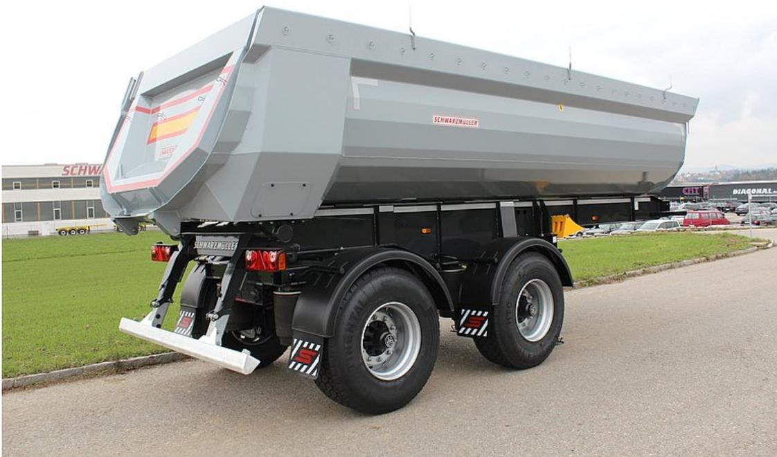
2-Achs-Stahl-Segmentmulden-Kippsattelanhänger - Radstand 1.810 mm
