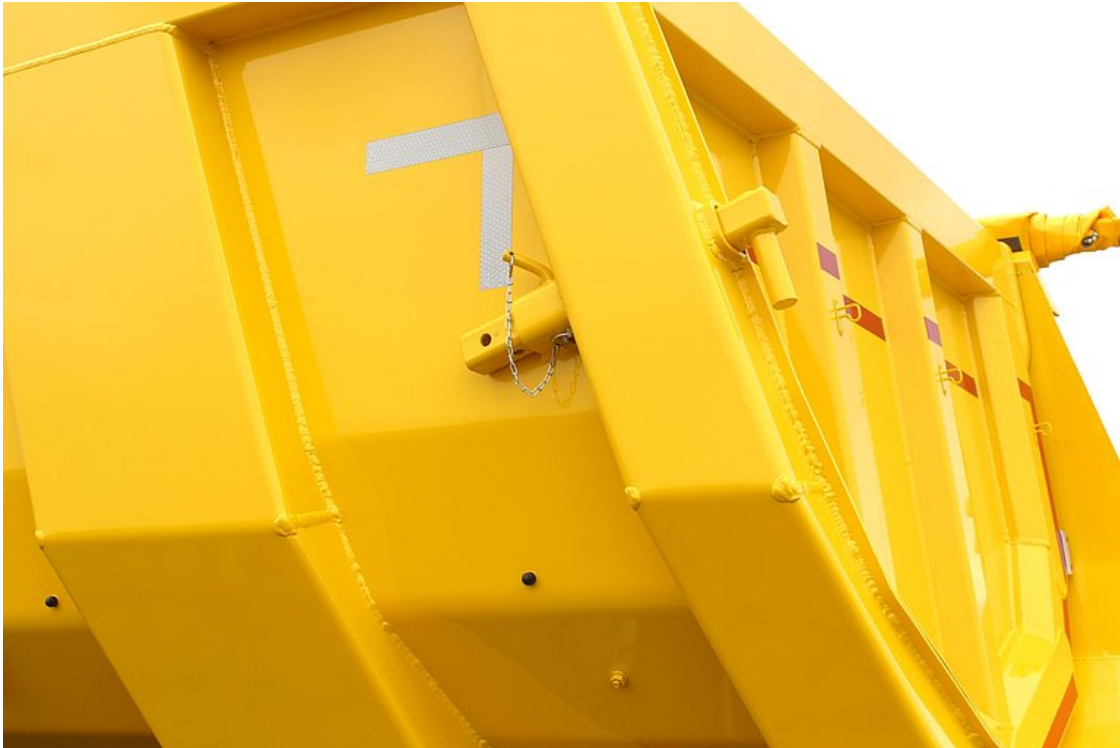
OPTIONAL: Dosiereinrichtung für Pendel-Rückwand mit ausziehbaren Rohranschlag
