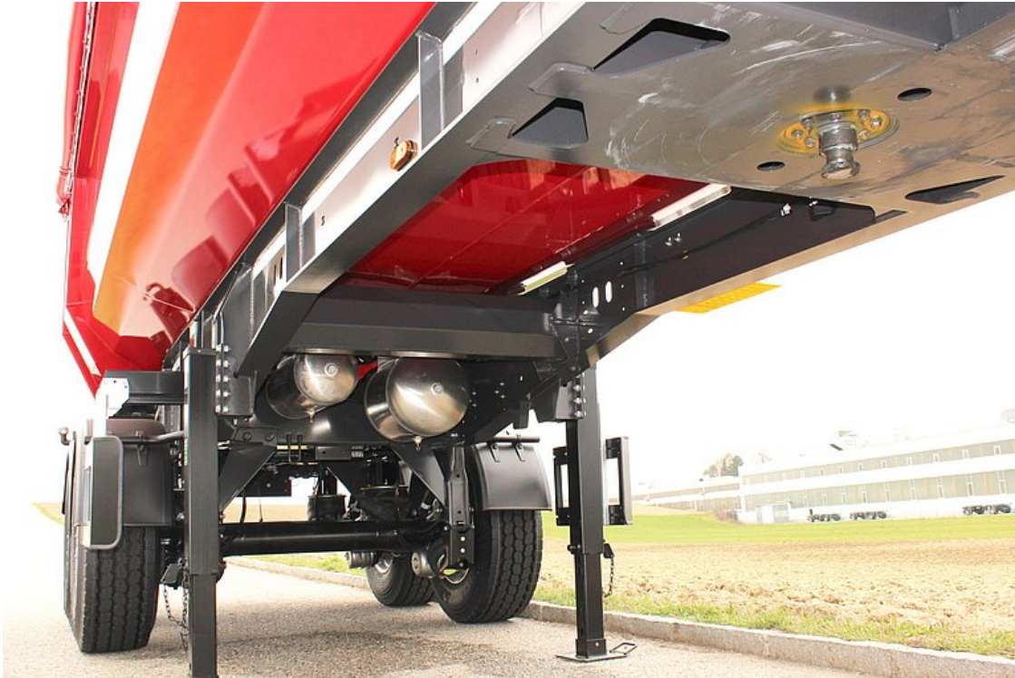
Stabile und verwindungssteife Fahrgestellkonstruktion mit zusätzlichen Torsionsrohren
