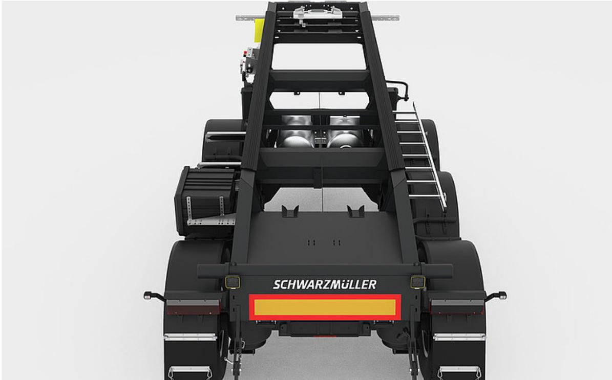
Ein Vorteil im Vergleich zu Fahrzeugen vieler Mitbewerber ist die parallele Führung der beiden Längsrahmen. So entsteht mehr Stabilität in jeder Situation.
