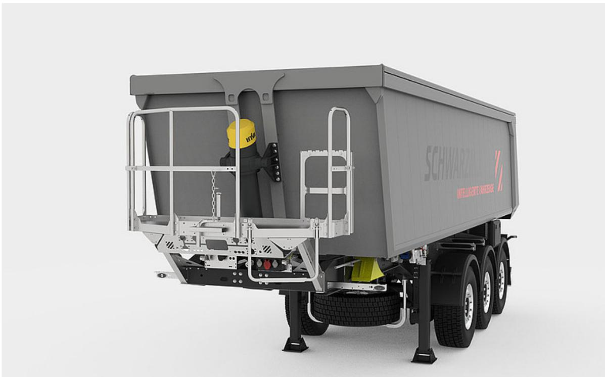
Das Stehpodest dient dem Aufstieg zur Mulde, der Überwachung des Ladevorgangs sowie dem Öffnen und Schließen der Abdeckplane.
