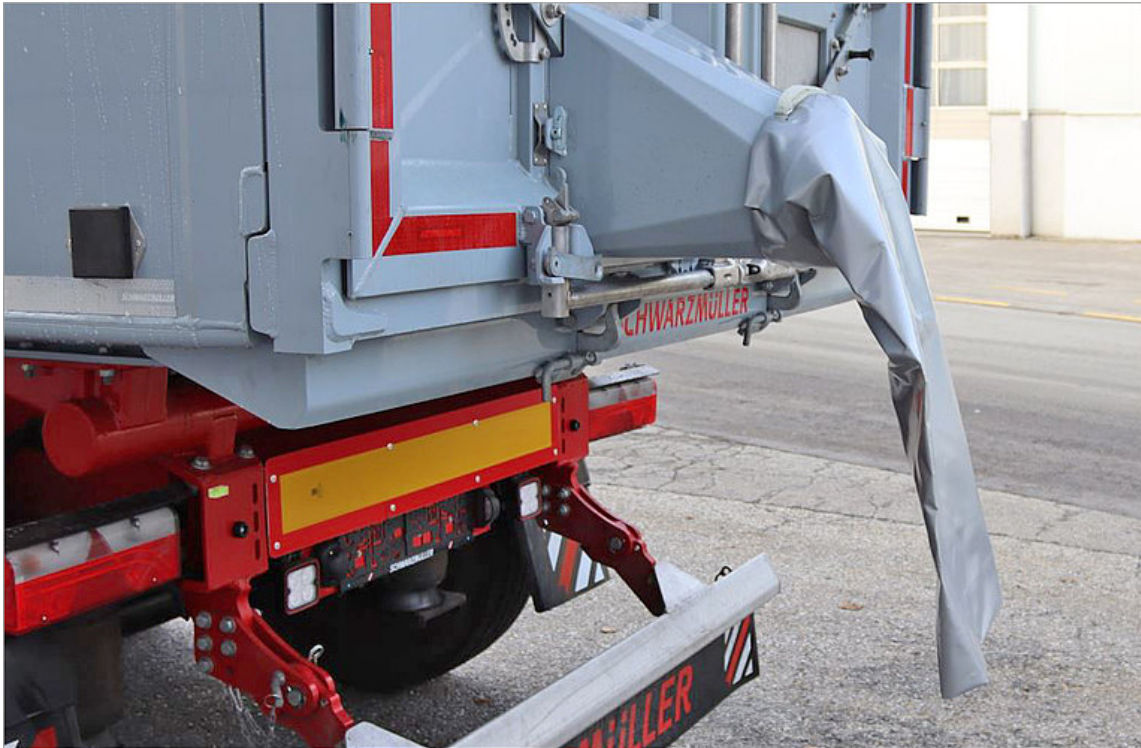
OPTIONAL: Staubsack - Der Staubsack ist ein einfaches Hilfsmittel zur Vermeidung einer Staubentwicklung.
