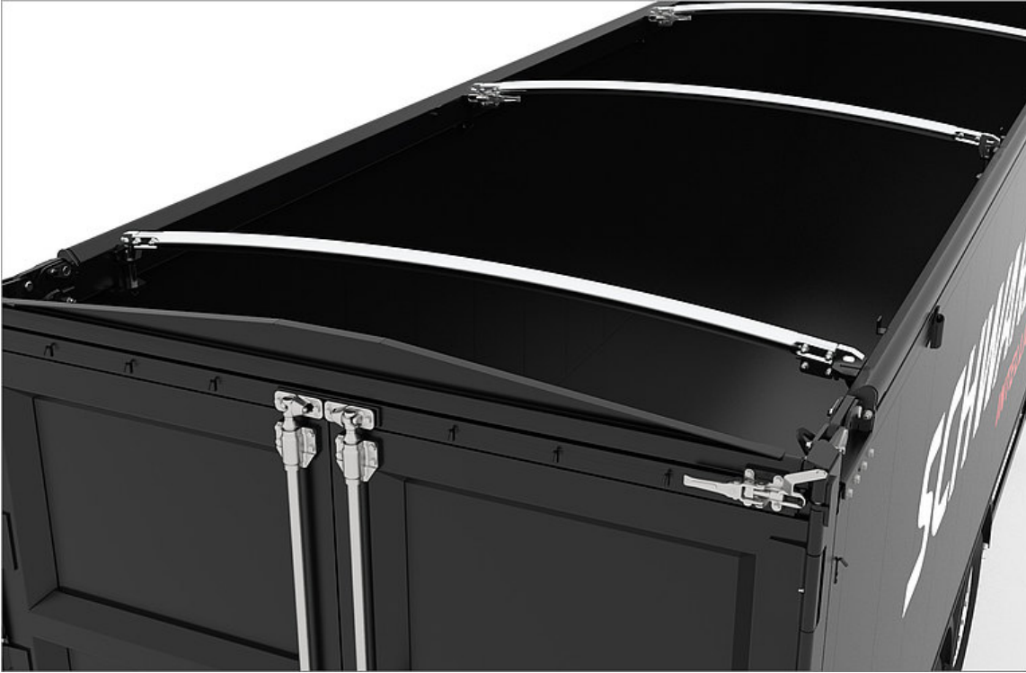
Dachbogen: Die materialabweisenden und runden Dachbögen bringen zusätzliche Stabilität in die Kippmulde. Diese sind schwenkbar für flexible Beladung und die Neigung reduziert eine mögliche Wassersackbildung.
