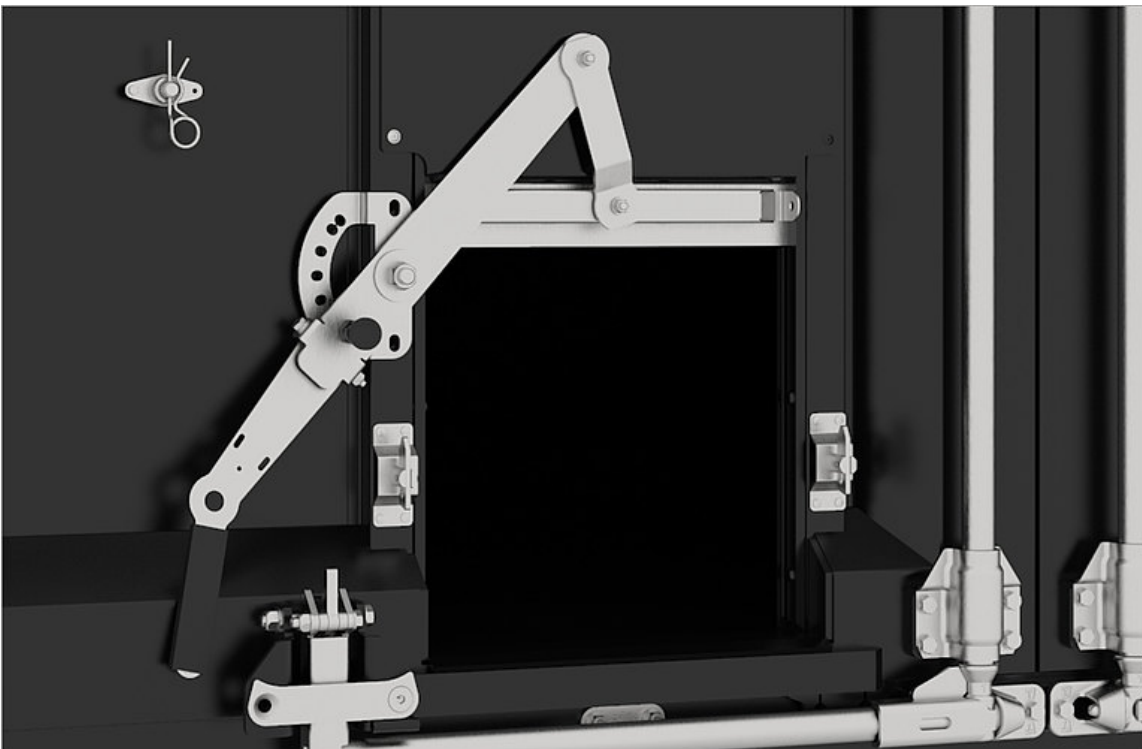
Getreideschieber: Die großdimensionierten Getreideschieber mit benutzerfreundlichen Bedienhebel lassen sich in verschiedenen Positionen arretieren.
