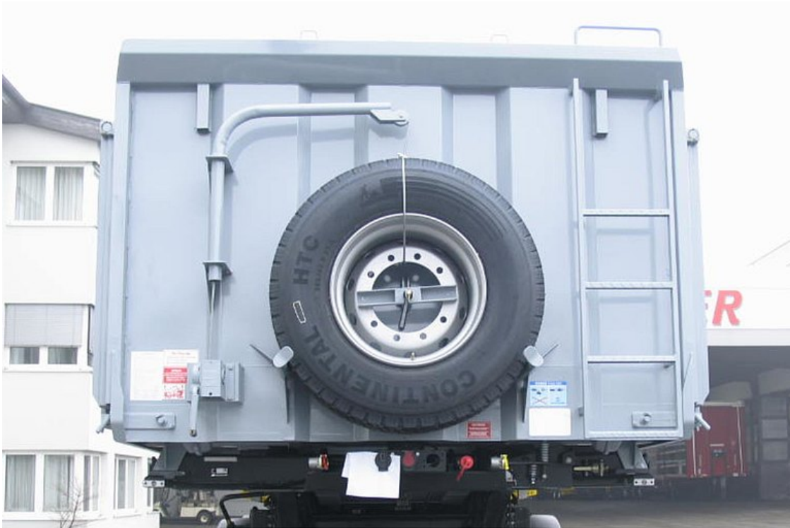
OPTIONAL: Ersatzradhalterung mit Schwenkgalgen und Aufziehwinde an der Vorderwand
