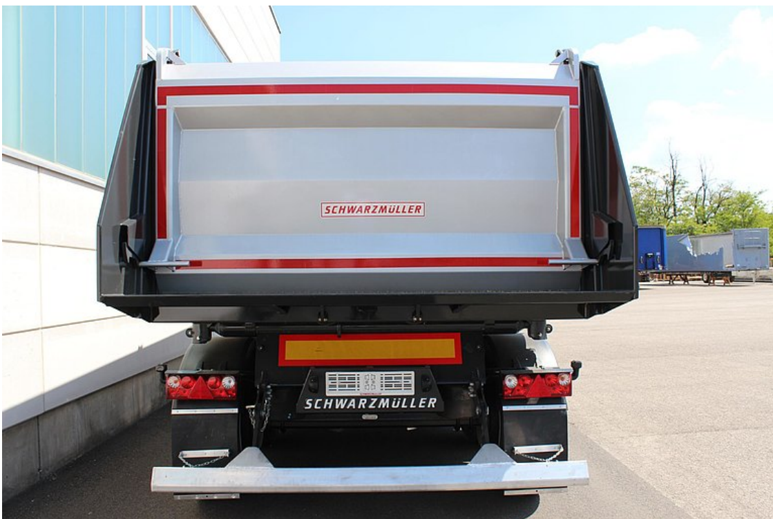
Stahlblech-Rückwand, pendelbar mit erhöhter Lagerung und autom. Pneumatikverschluss
