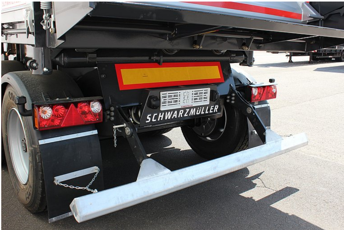
Klappbarer Unterfahrschutz für Fertigereinsatz
