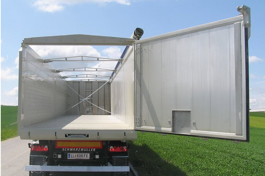
Kombinierte-Rückwand - 1-flügelige vollumschlagbare Türe und zusätzlich pendelbar mit autom. Pneumatikverschluss
