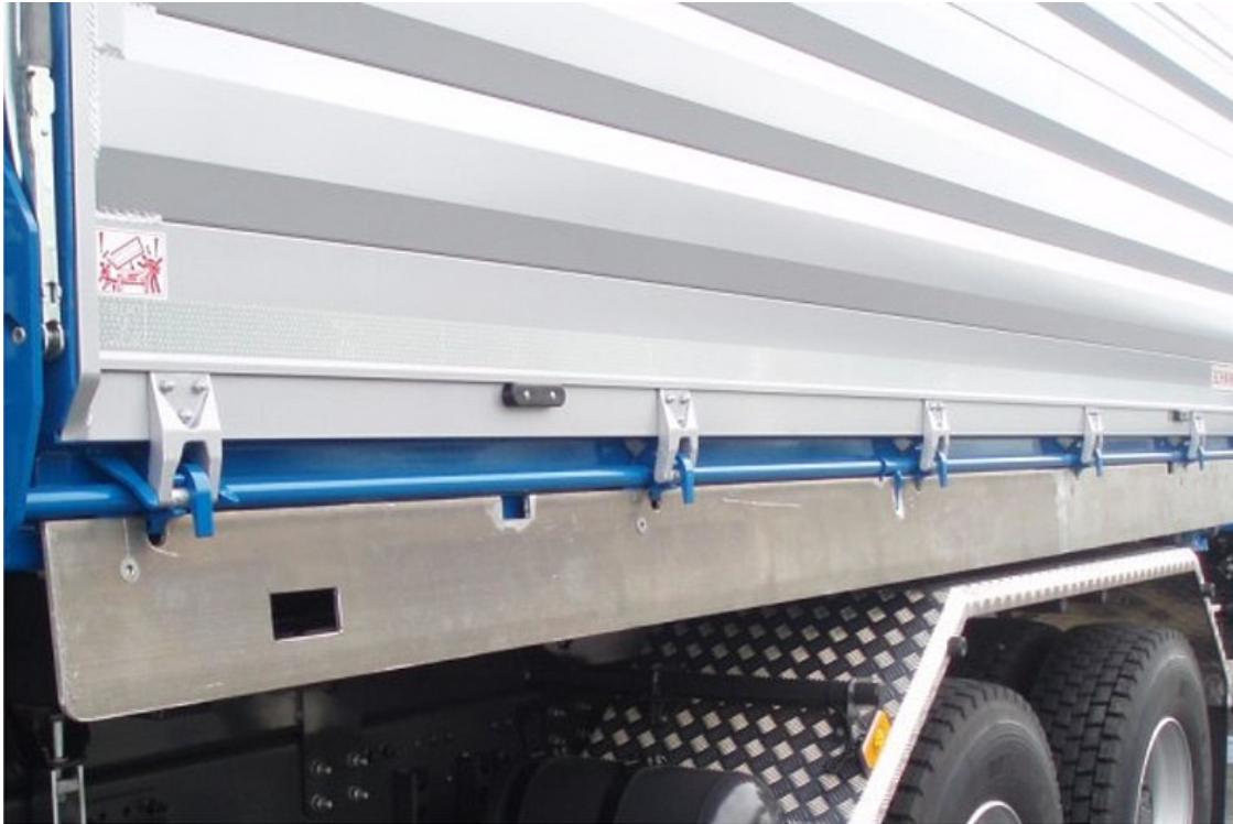
OPTIONAL: Aluminium-Klappe auf seitlicher Zentralverriegelungswelle
