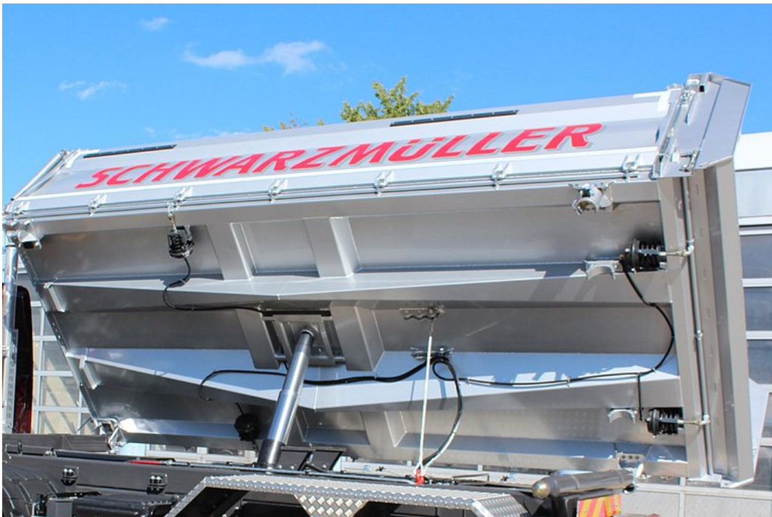
Kipperbrückenkonstruktion mittels konischer Trapezprofil-Längsträger in hochfester Leichtbauweise mit kleinen Bodenfeldern für große Beulfestigkeit und hoher Stoßabfederung
