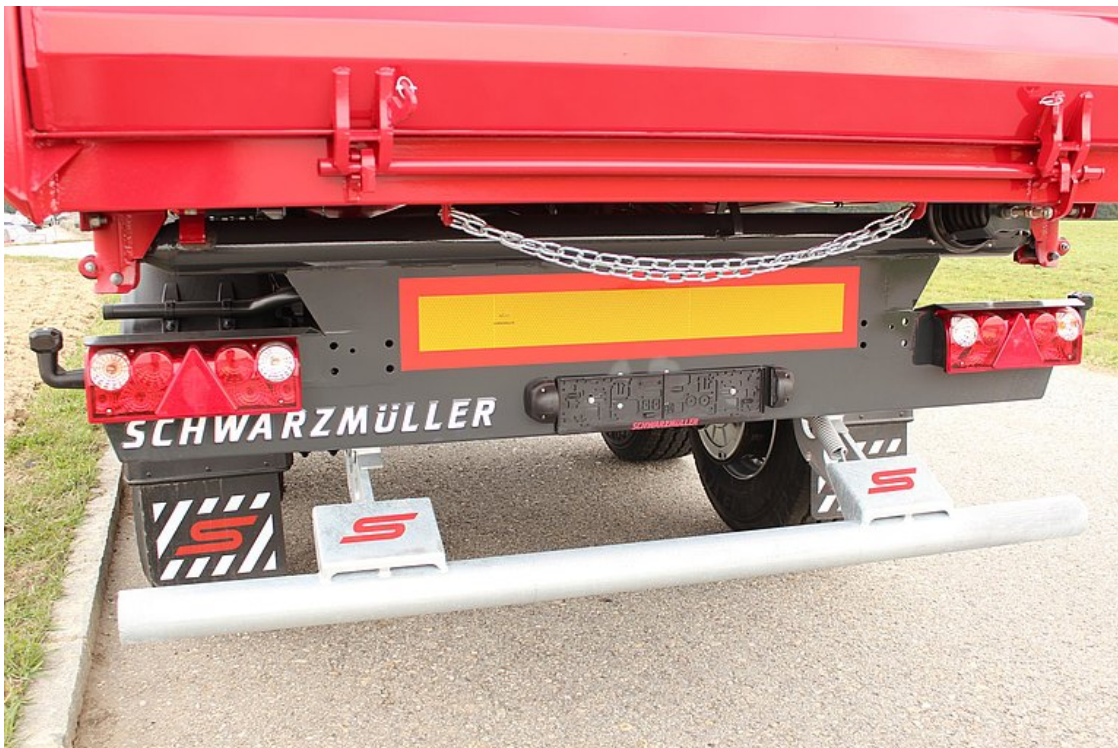
Rohr-Unterschuttschutz klappbar, mit Anfahrbock für Fertiger
