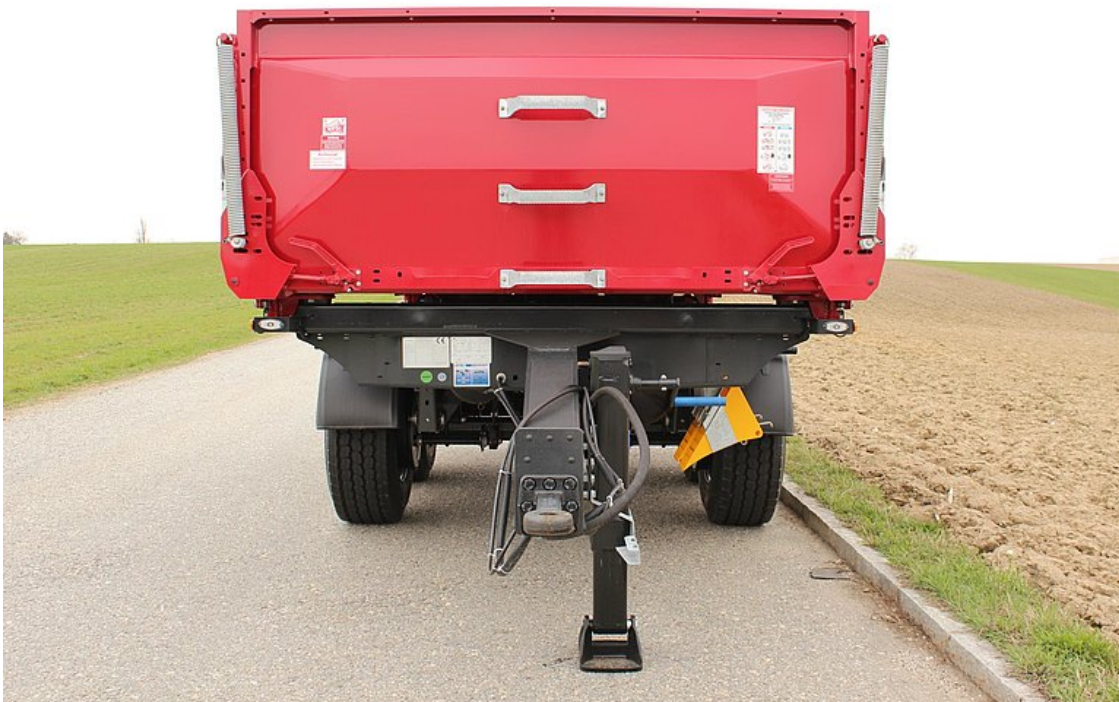
Stahlblech-Vorderwand mit Aufstiegsbügel außen und innen
