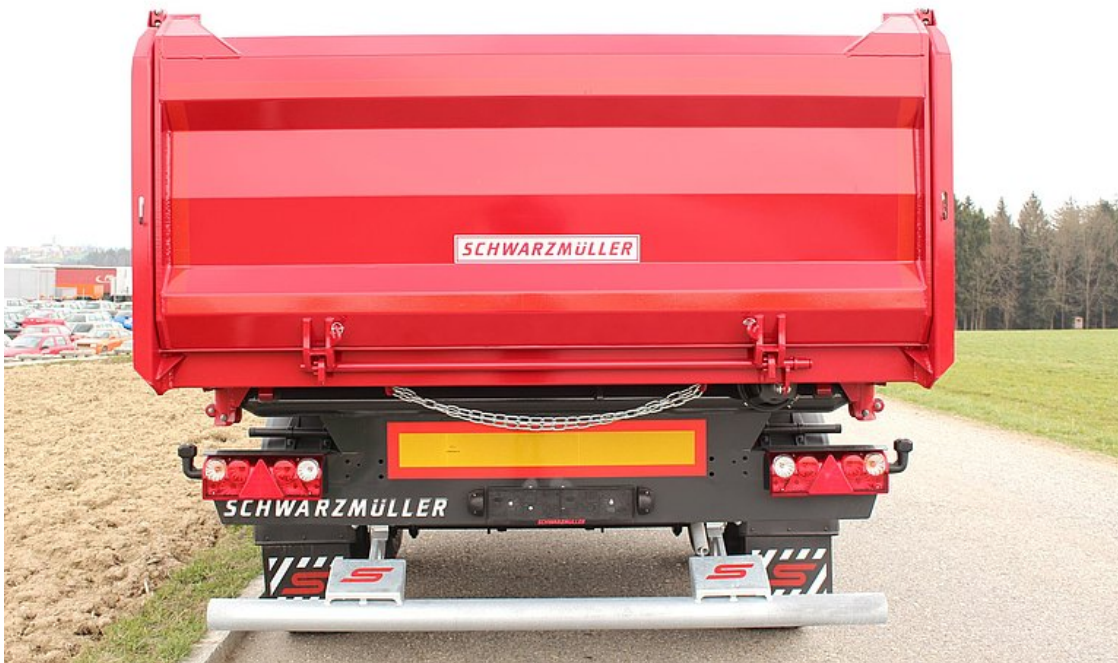
Stahlblech-Rückwand pendelbar, mit erhöhter Lagerung und autom. Pneumatikverschluss
