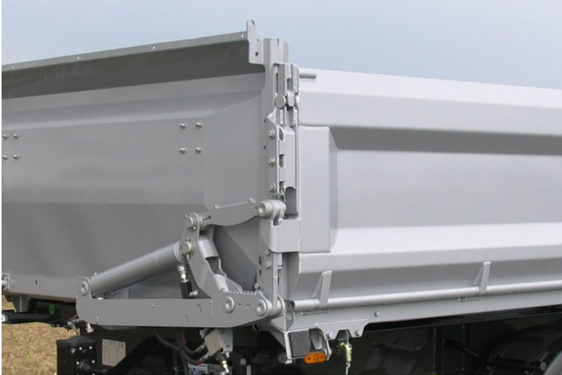
OPTIONAL: Linksseitig Bordmatic = hydraulisch abklappbare Seitenbordwand, mit doppelwirkendem Zylinder an der Vorderwand, vom Fahrerhaus zu betätigen
