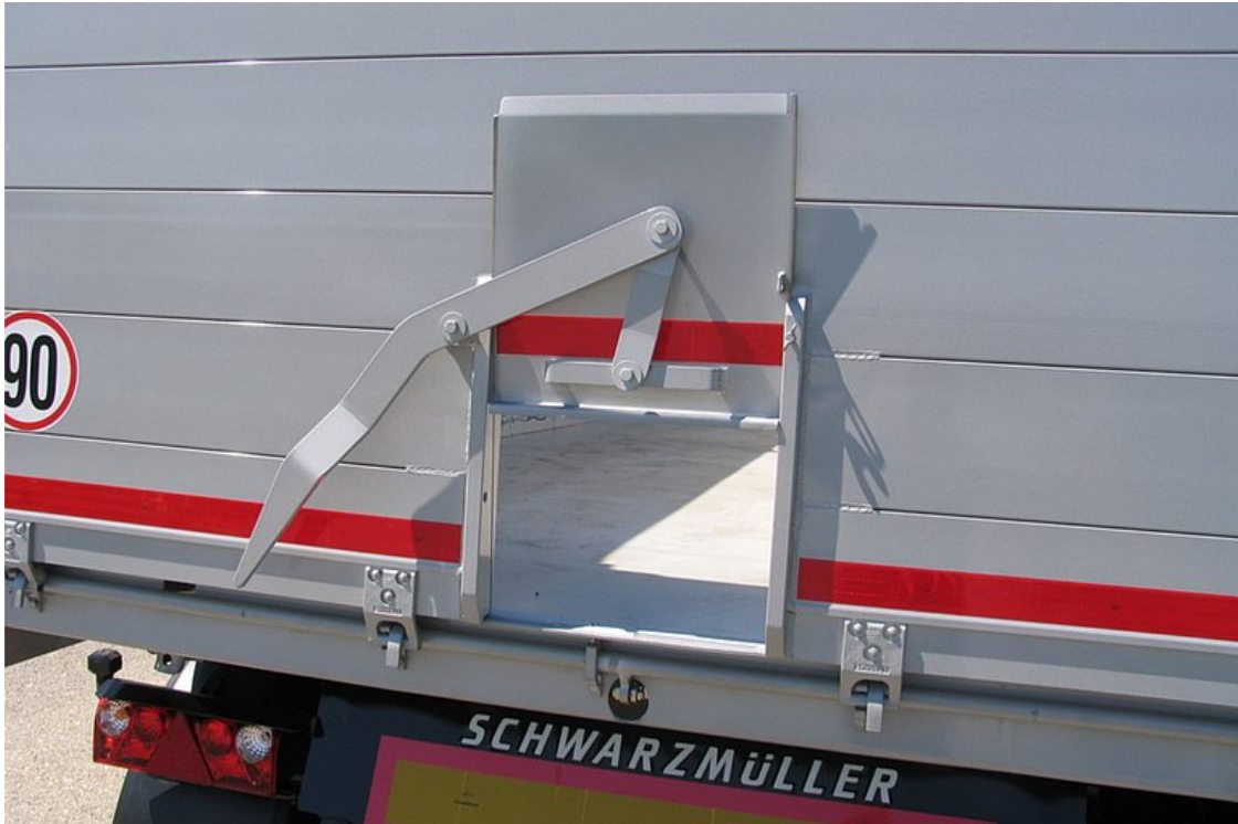
OPTIONAL: Getreideschuber ca. 400/400 mm mit seidl. Dosierhebel in Rückwand und Wasserschutzblech
