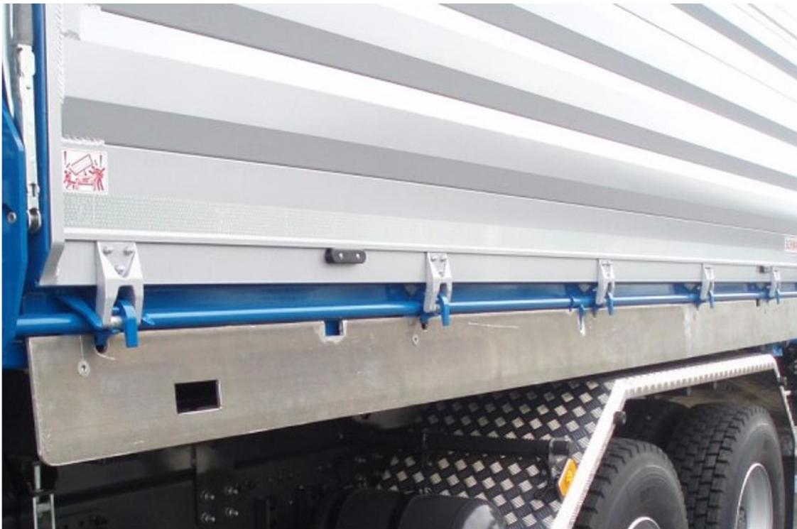
OPTIONAL: Aluminium-Klappe auf seitlicher Zentralverriegelungswelle
