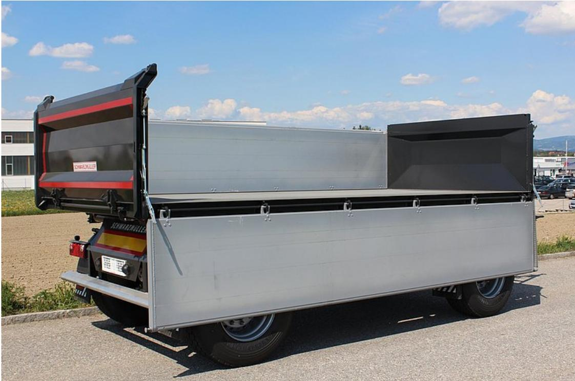
2-Achs-3-Seiten-Kipphanhänger mit abgeklappter Seitenwand
