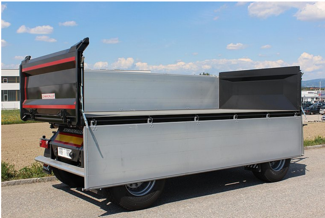
2-Achs-3-Seiten-Kippanhänger mit abgeklappter Seitenwand
