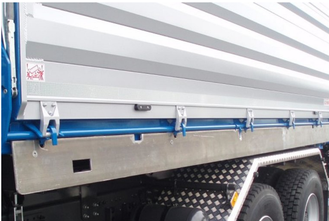
OPTIONAL: Aluminium-Klappe auf seitlicher Zentralverriegelungswelle
