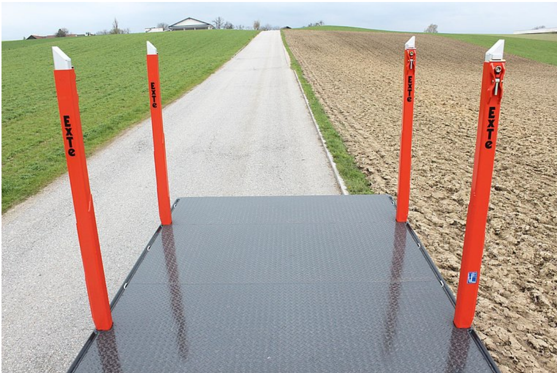
Exte-Rungentaschen mit Verstärkungsträger samt 2-teiligen Exte-Rungen 144-S mit Schraubenbefestigung (Belastbarkeit 7 t/Paar)
