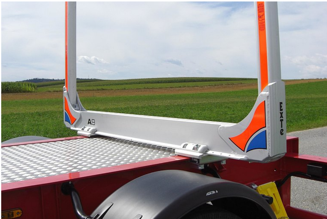
Insgesamt 2 ExTe-Rungenstöcke samt 2-teilige ExTe-Rungen 144 mit Schraubenbefestigung (Belastbarkeit 7 t/Paar)
