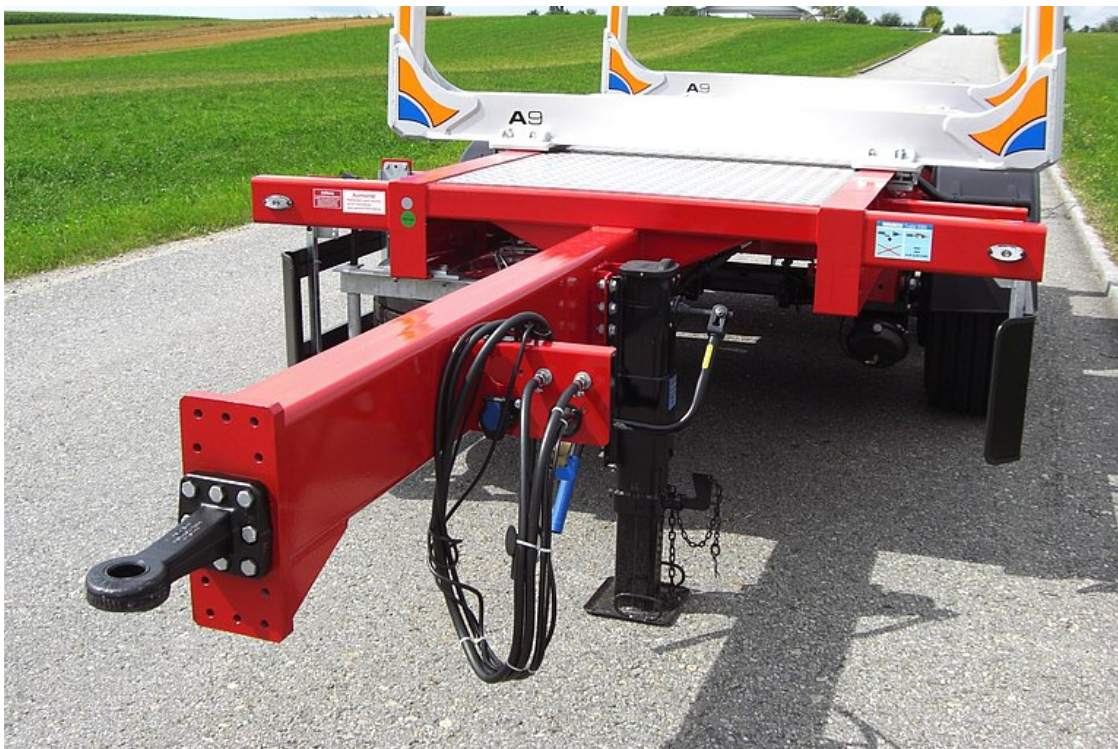
Höhenverstellbare Zugstange für Zentralachs-Schwerlastkupplung
