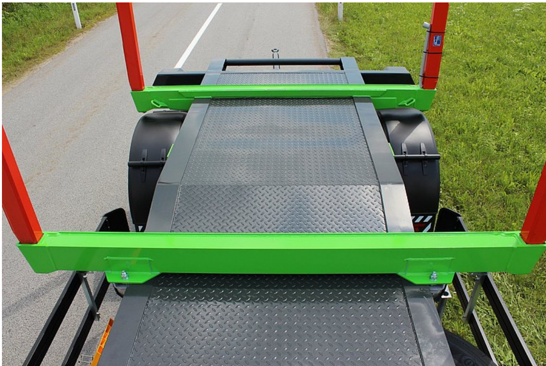
Stahltränenblech-Abdeckung zwischen den Rahmenlängsträgern
