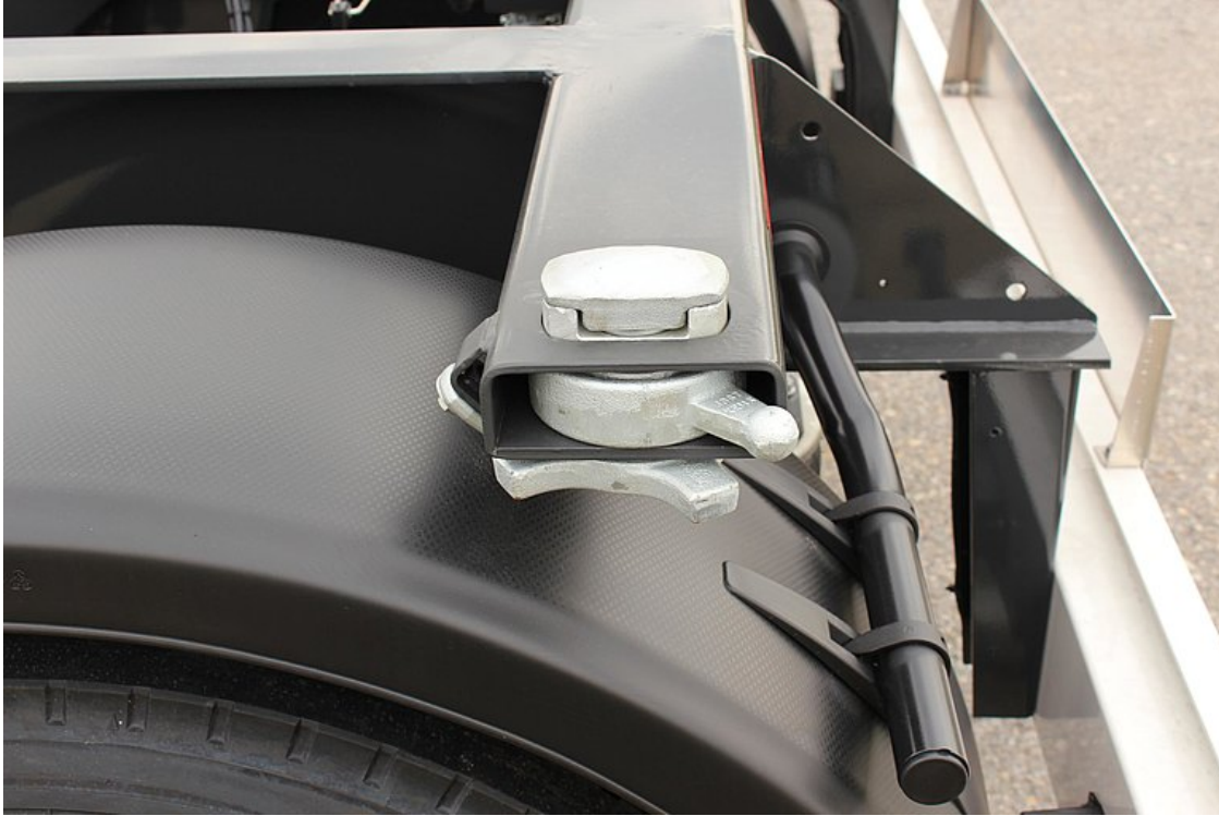
Auflagräger samt 4 Containerverschlüsse nach EN 284 (20ft-Verriegelungsmaß)
