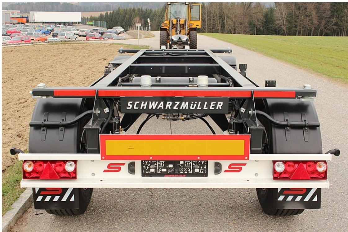
Unterfahrschutz inkl. integriertem Leuchtsystem
