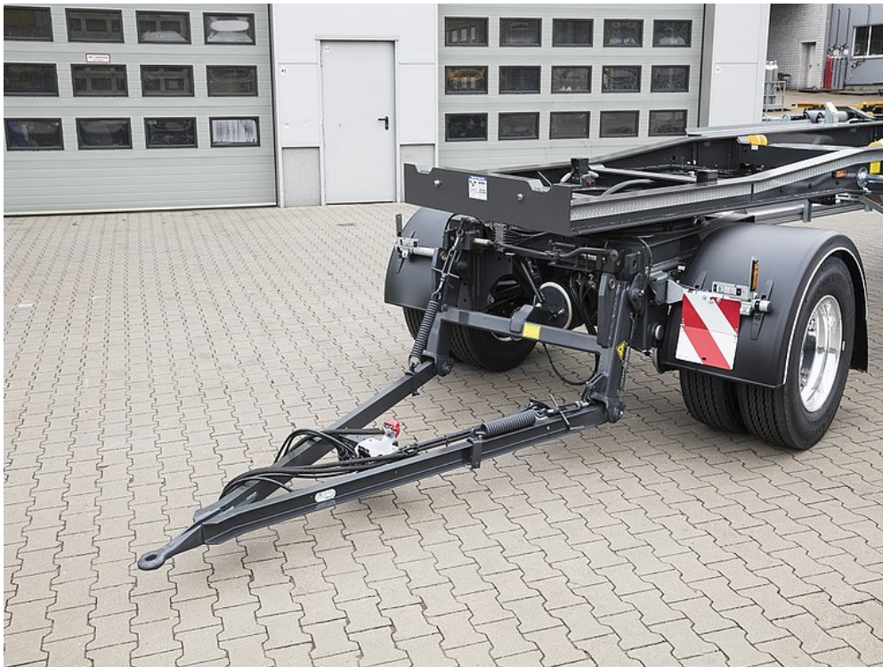
Abgesenkte Zuggabel bei Frontbeladung
