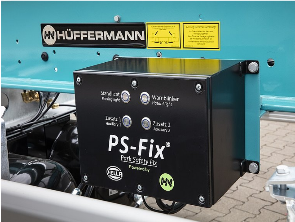
OPTIONAL: Das autarke Beleuchtungssystem für mehr Sicherheit
