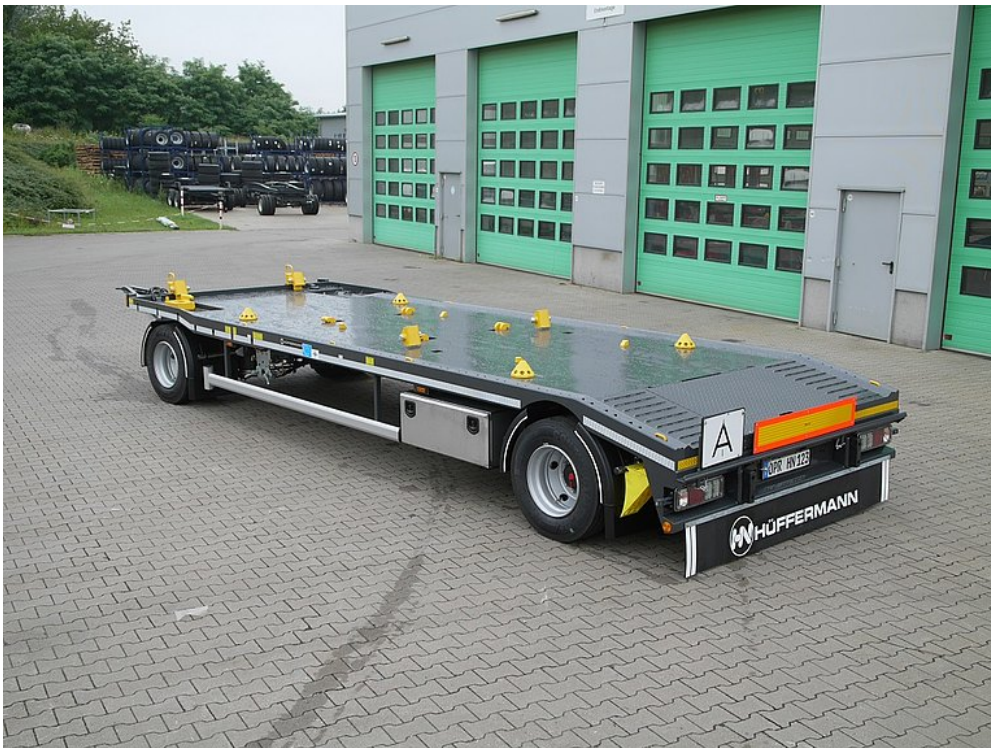
Außenrahmen mit versenkbaren Zurrpunkten und ASK Ausstattung
