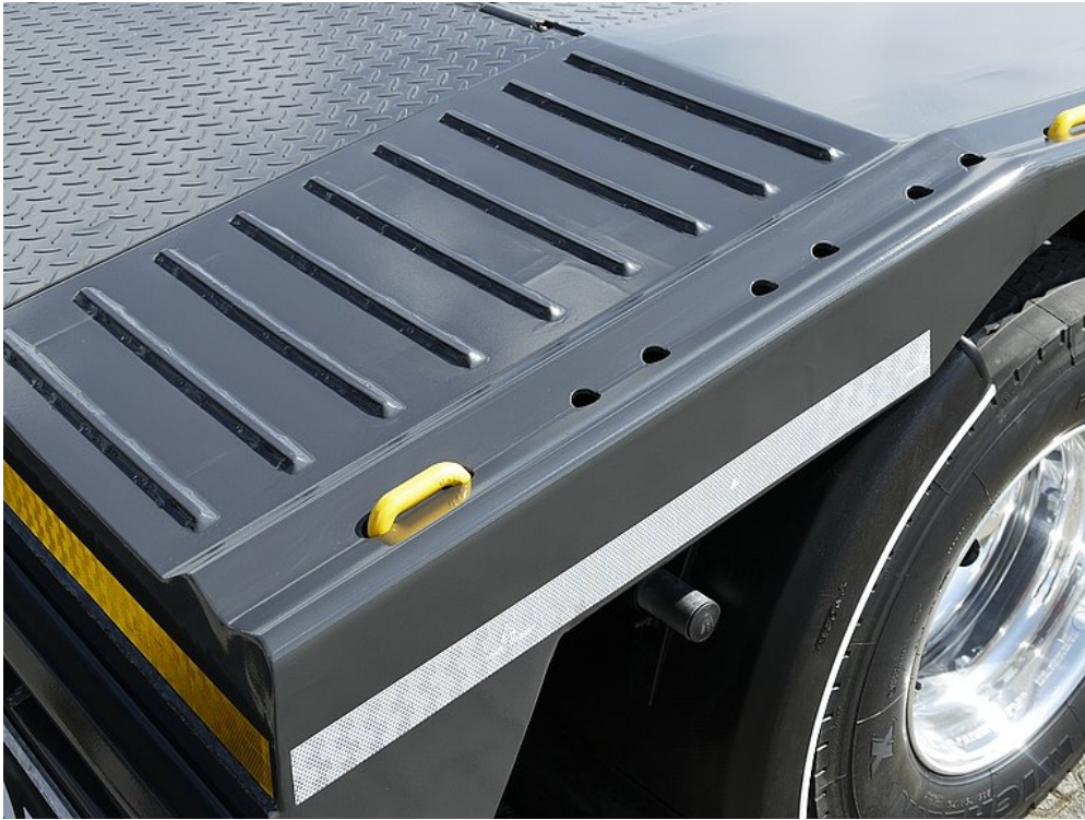
Versenkte und variabel umschraubbare Zurrpunkte im Außenrahmen
