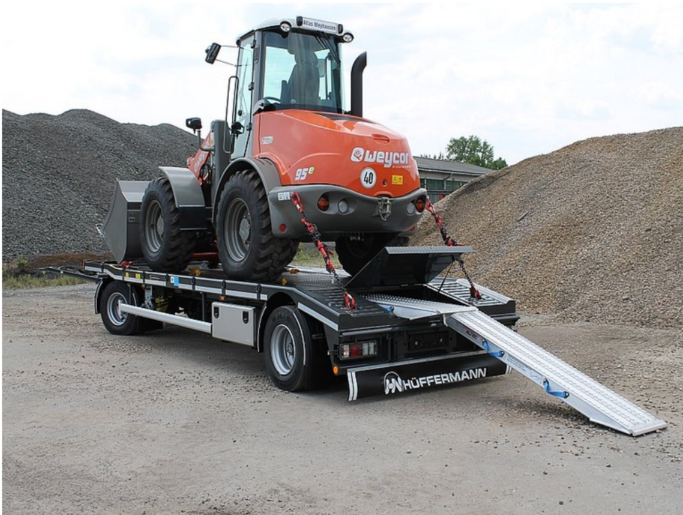
Verzurrung von Baumaschinen
