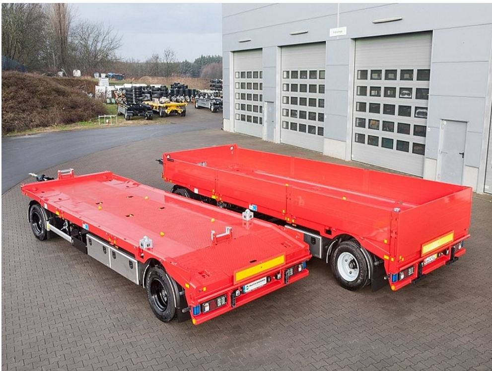
OPTIONAL: Links: ISO-Container Aufnahme, Seilwindenfenster. Rechts: Aluminiumbordwände
