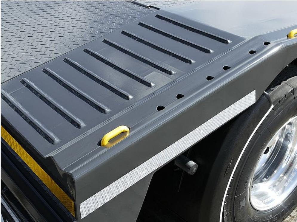
Versenkte und variabel umschraubbare Zurrpunkte im Außenrahmen
