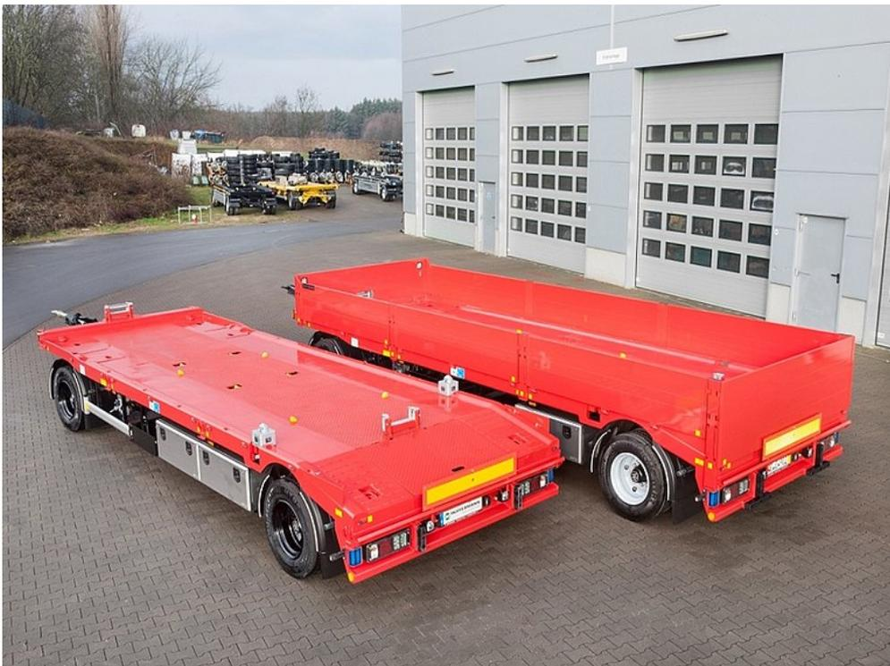
OPTIONAL: Links: ISO-Container Aufnahme, Seilwindenfenster. Rechts: Aluminiumbordwände
