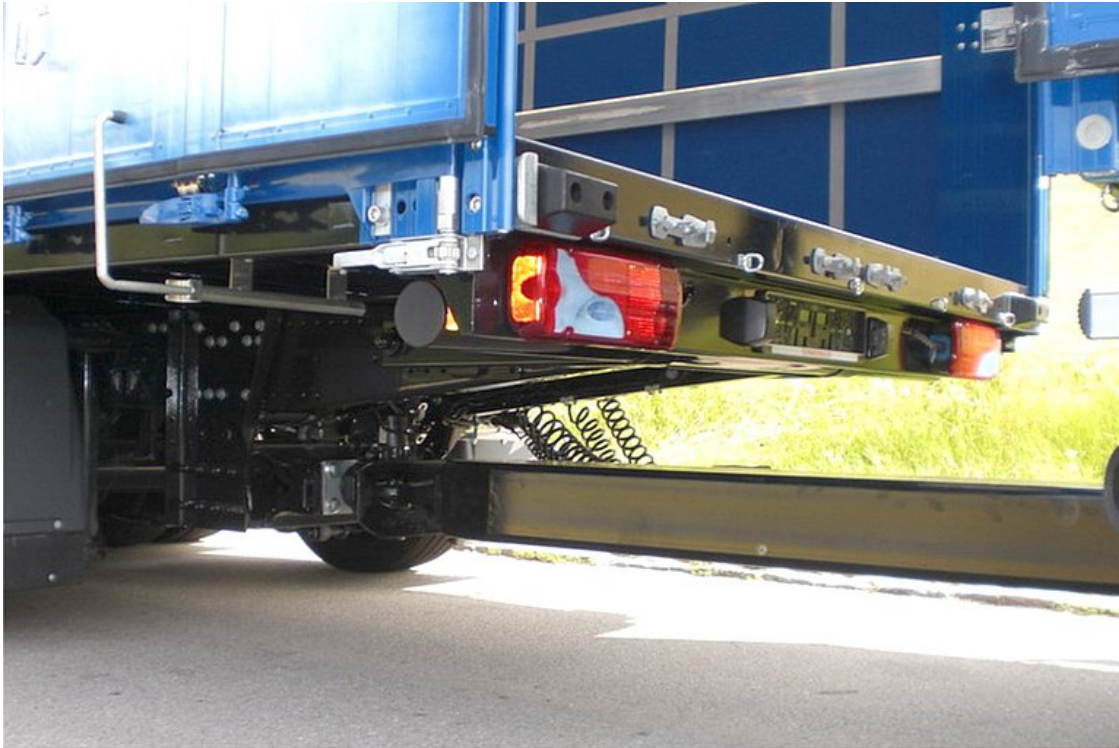
Spezialanhängevorrichtung für Zentralachsanhänger-Kurzabstand
