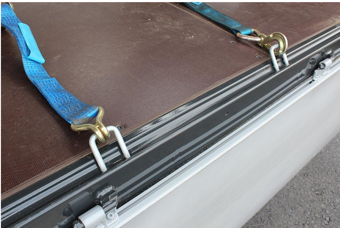
Zurrbügel-Außenrahmen mit versenkten 2,5 t Zurrbügel
