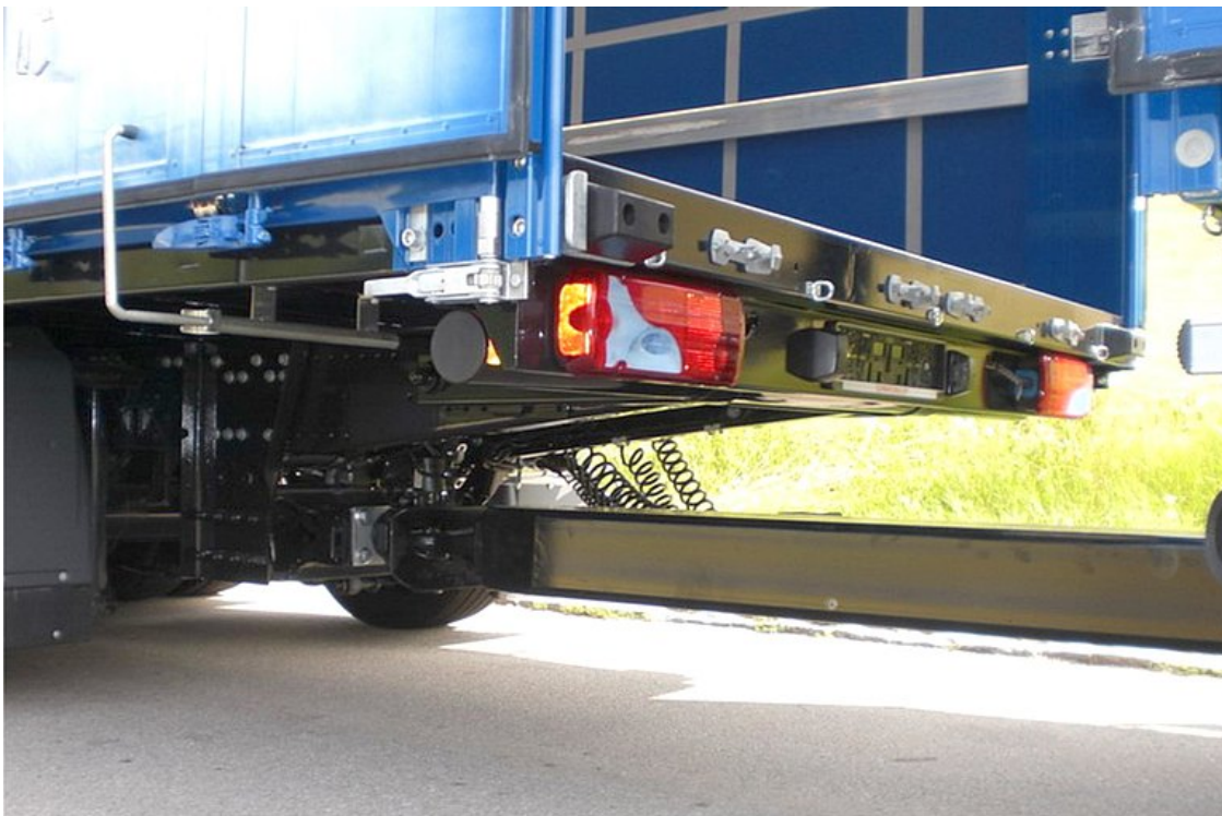
Spezialanhängervorrichtung für Zentralachsanhänger-Kurzabstand
