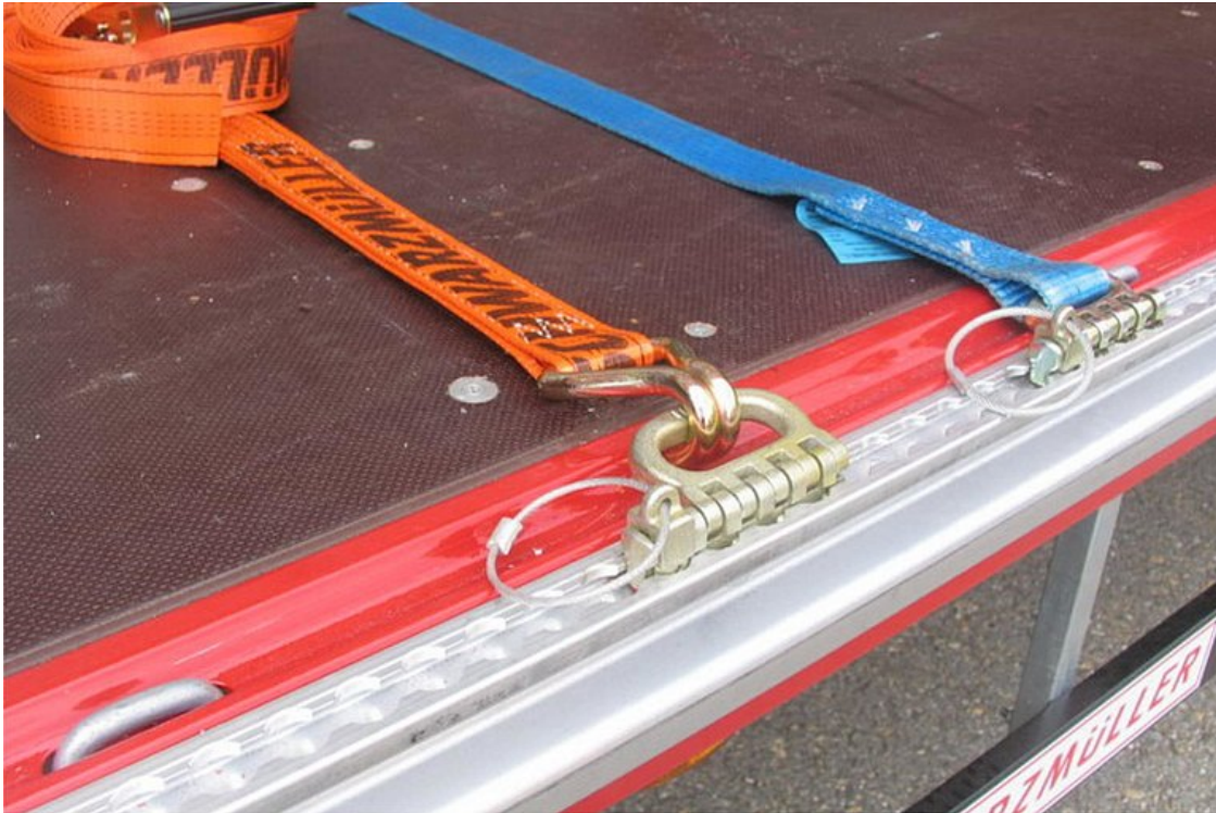
OPTIONAL: Variable Ladungssicherung mittels anschraubbarer Zurrsysteme - z.B.: Airline Zurrschiene
