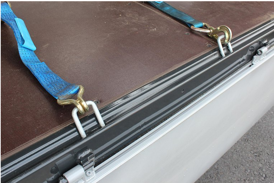
Zurrbügel-Außenrahmen mit versenkten 2,5 t Zurrbügel
