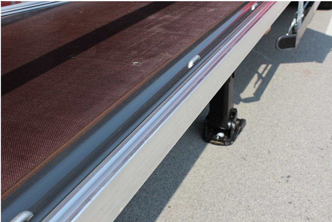
Beidseitig aufgeschraubte Aluminium-Kombi-Rammleiste, als zusätzlichen Anfahrtschutz, mit integrierter Planeneinhängung und Lattenfixierung
