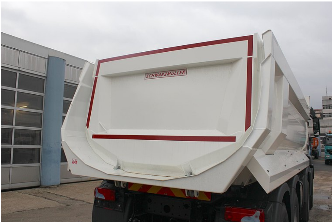
Stahlblech-Rückwand = Pendelwand mit versenkter Lagerung
