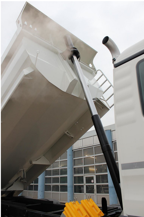
Hartverchromter, qualitativ hochwertiger Frontkippzylinder
