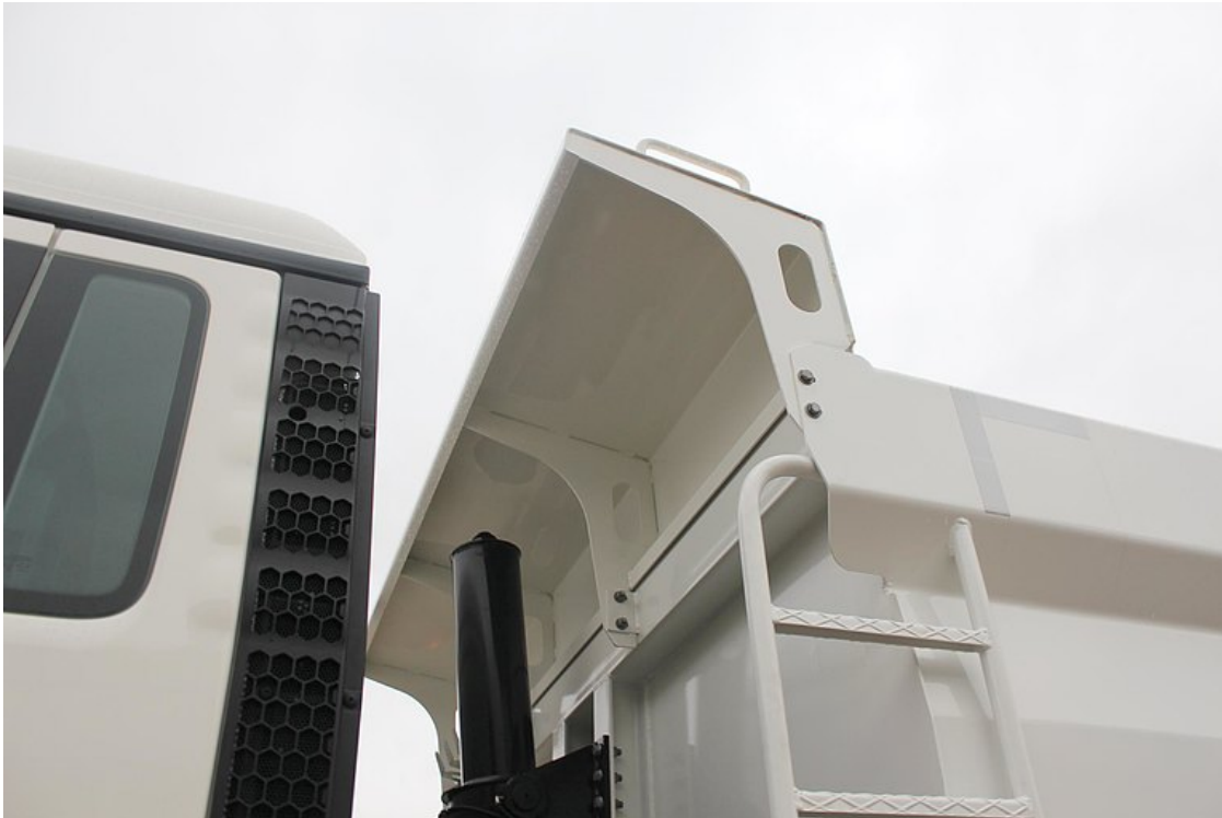
Vorderwand oben mit erhöhtem Baggerschutz
