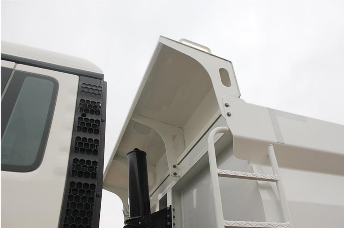
Vorderwand oben mit erhöhtem Baggerschutz
