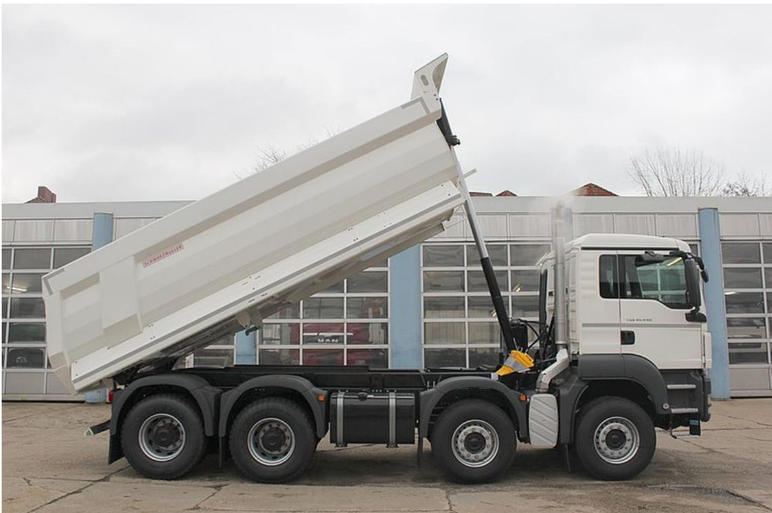
Stahl-Segmentmulden-Kippaufbau auf 4-Achs-LKW
