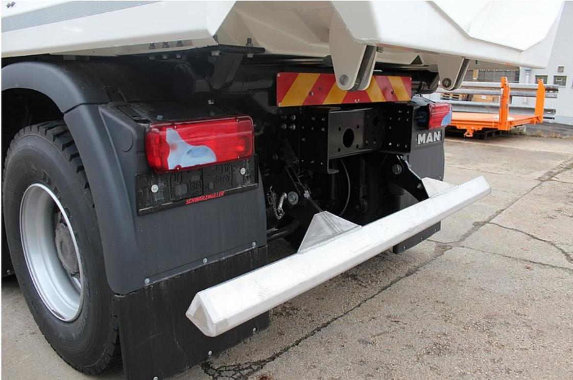
OPTIONAL: Hochklappbarer Aluminium-Unterfahrschutz
