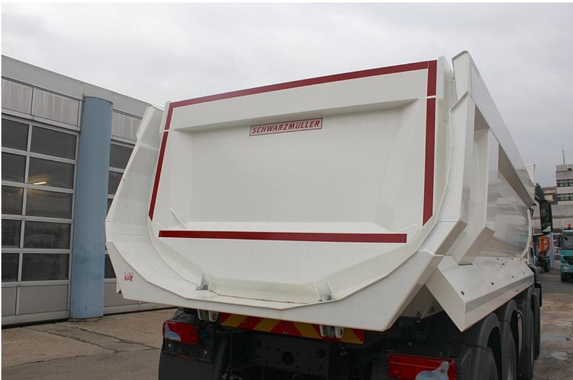
Stahlblech-Rückwand = Pendelwand mit versenkter Lagerung
