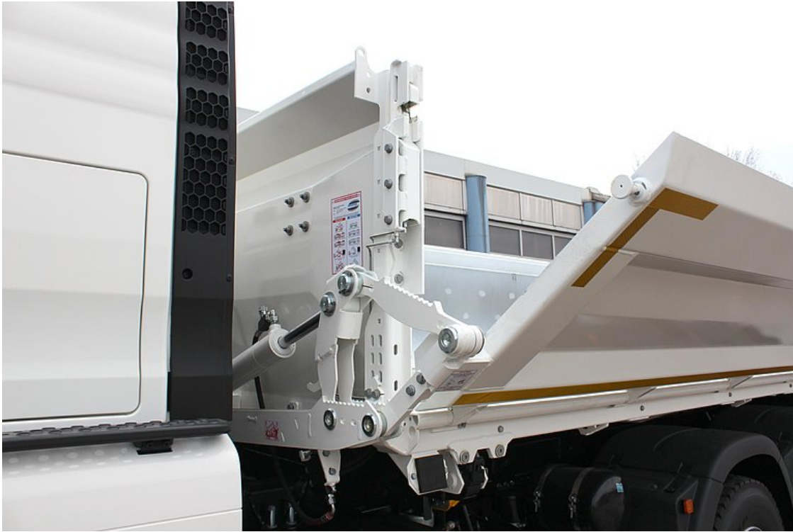
OPTIONAL: Linksseitig Bordmatic = hydraulisch abklappbare Seitenbordwand
