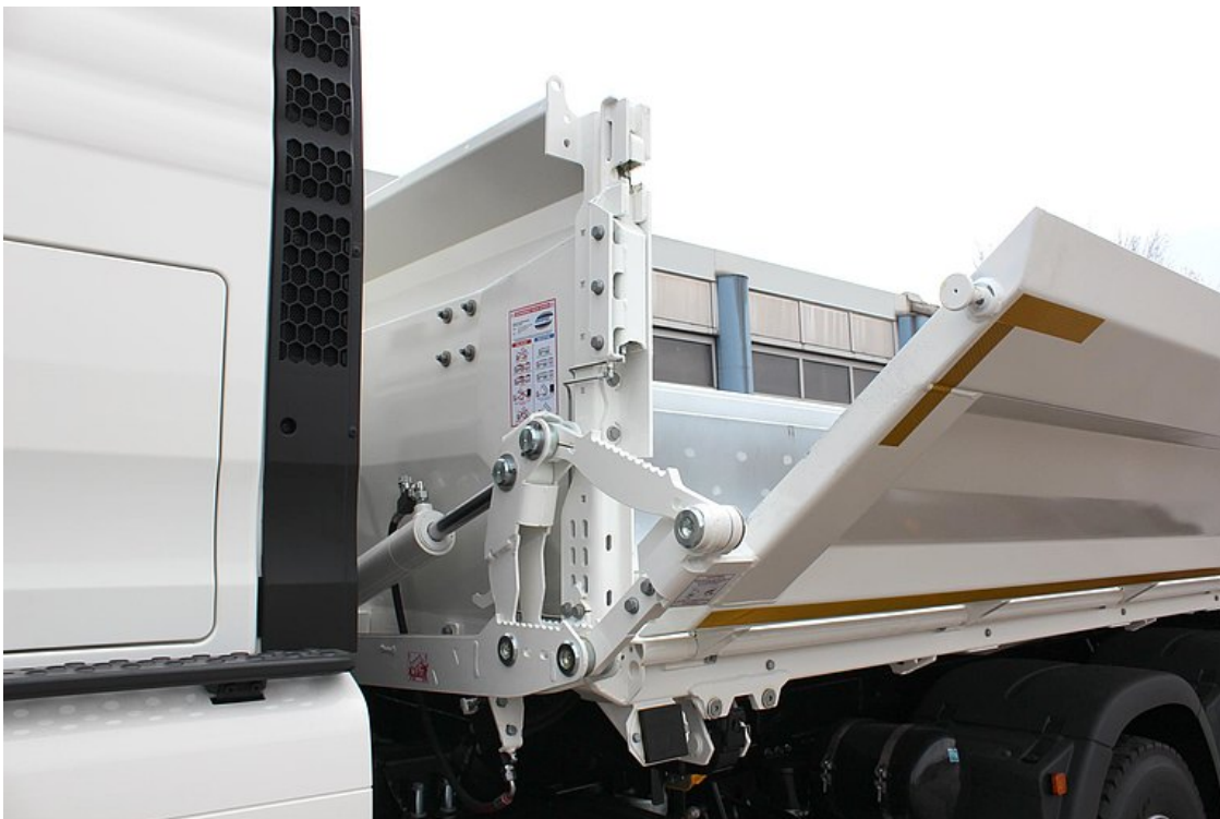
OPTIONAL: Linksseitig Bordmatic = hydraulisch abklappbare Seitenbordwand
