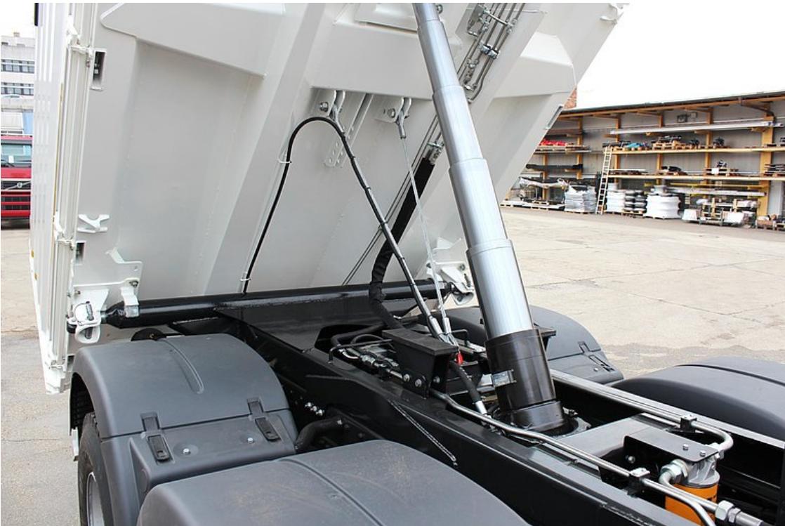
Hartverchromter, qualitativ hochwertiger Kippzylinder
