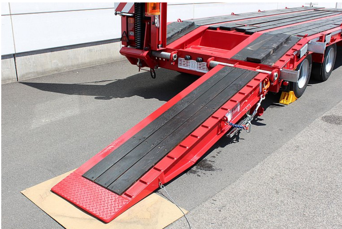
Auffahrampen mit Hartholzbelag und aufgeschweißten Vierkantrippen
