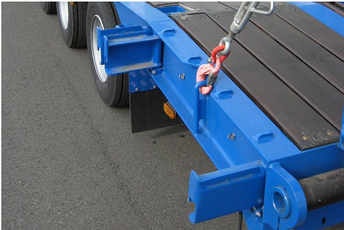
Klappbare, ausschwenkbare Verbreiterungen, inkl. Verbreiterungsbohlen für Überbreitetransporte
