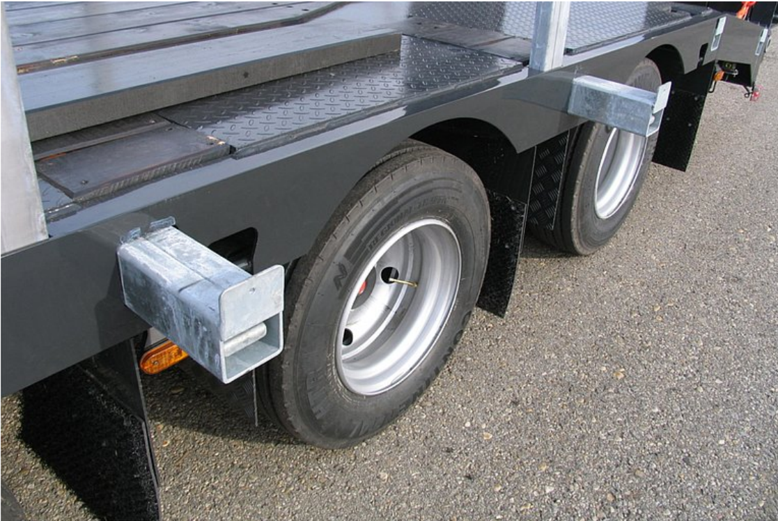
Ausziehbare Verbreiterungen, inkl. Verbreiterungsbohlen für Überbreitetransporte
