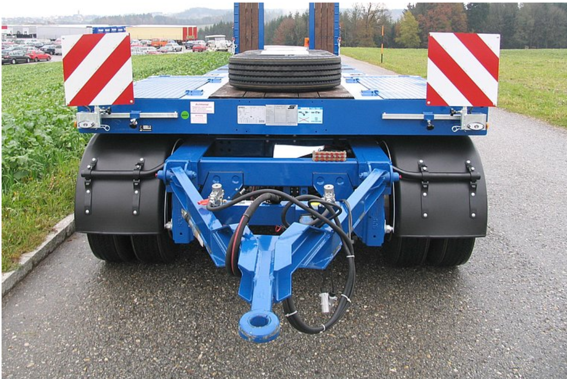
Vorderes Kröpfungsplateau mit Zubehörfächern und ausziehbaren Warntafeln für Überbreitetransporte
