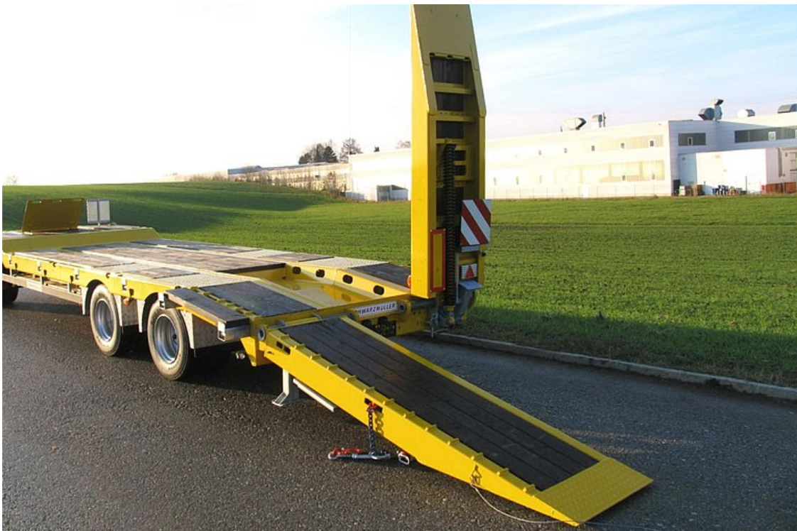
2 Klappbare 1-teilige Auffahrampen mit Hartholzbelag
