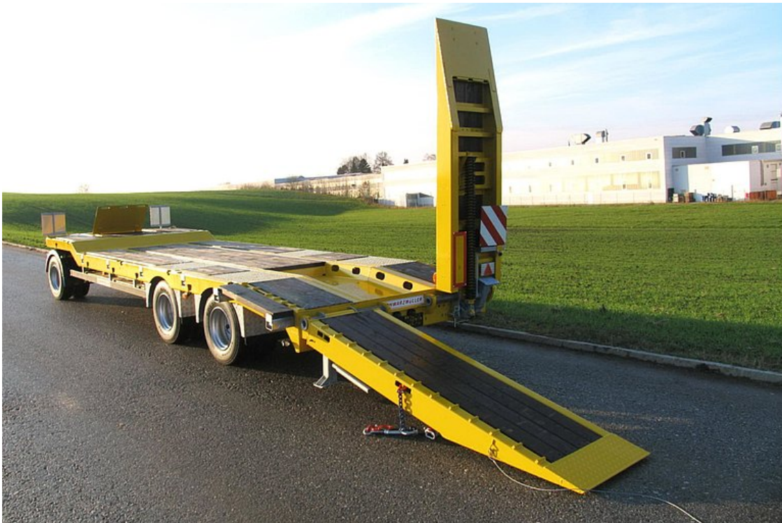
2 Klappbare 1-teilige Auffahrampen mit Hartholzbelag
