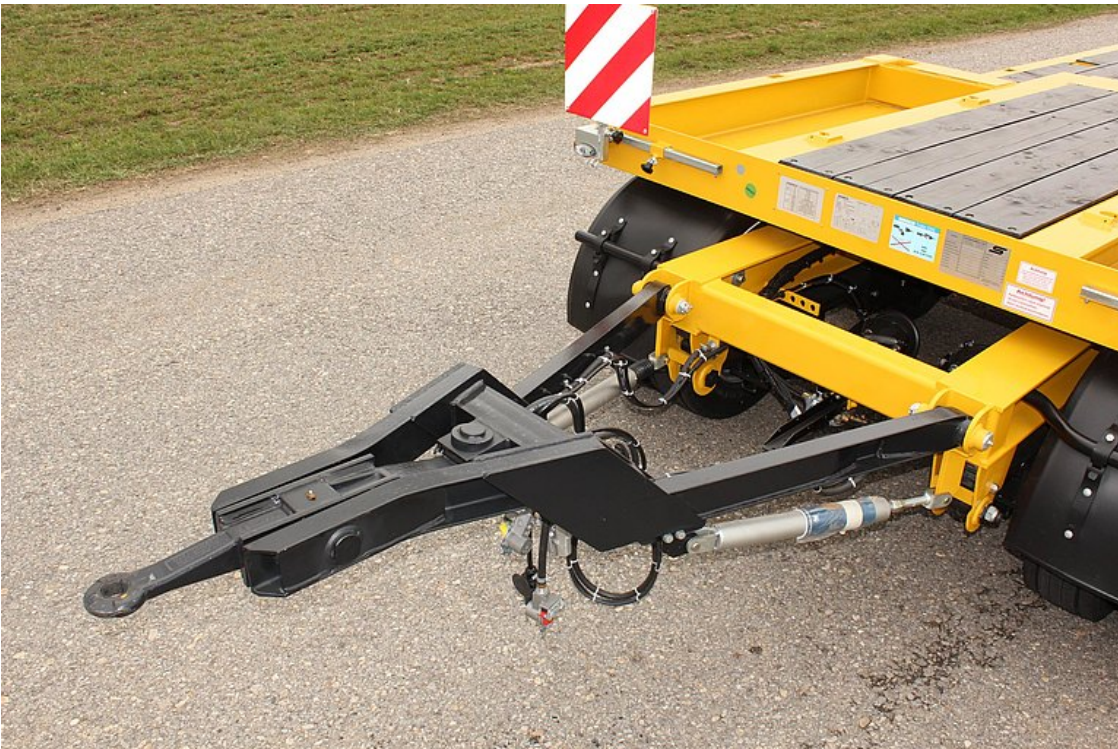
Gekröpfte Zuggabel mit Schwenkzugöse 40 + 50 mm
