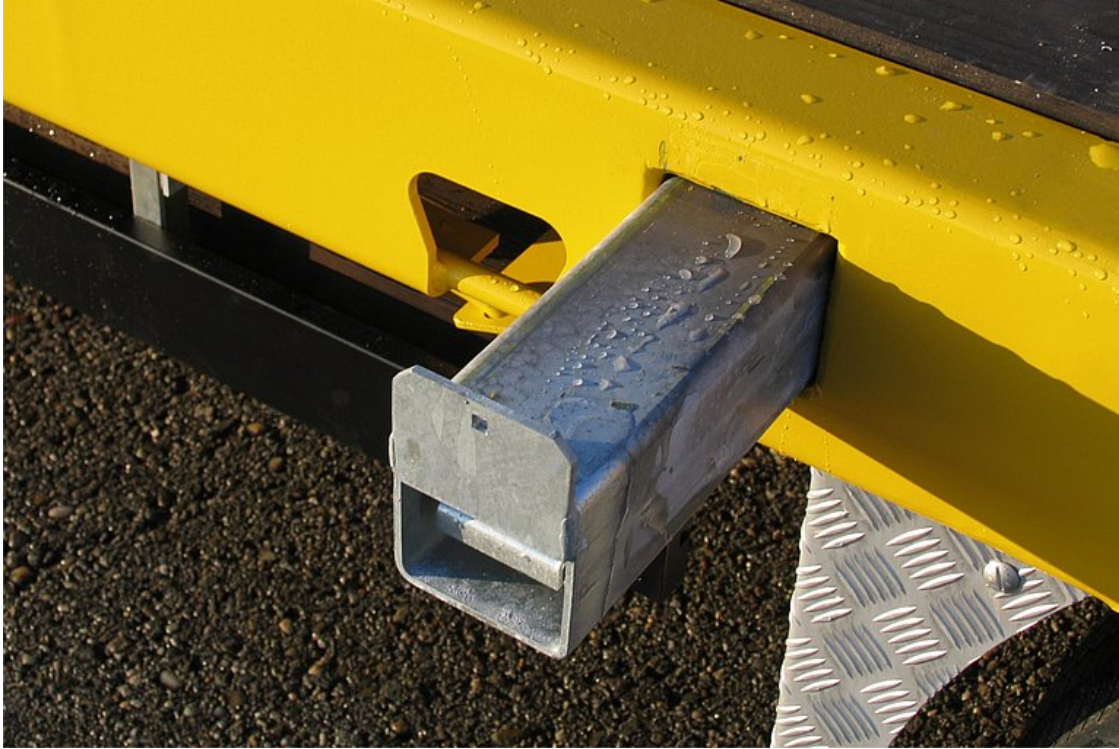
Ausziehbare Verbreiterungen, inkl. Verbreiterungsbohlen für Überbreitetransporte
