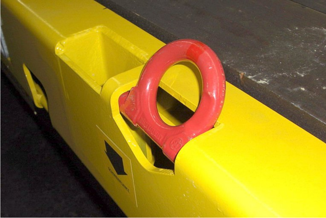
7 Paar versenkte hochklappbare Zurringe
